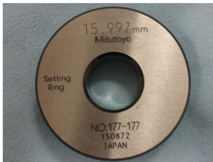
Slika 27. Kontrolni mjerni prsten \varnothing 15,997 mm
