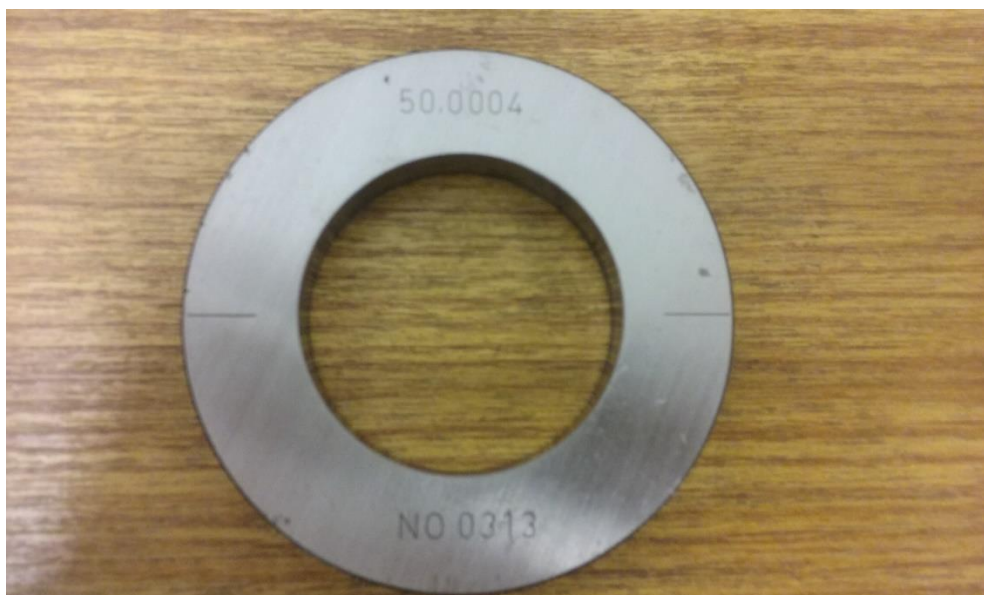
Slika 17. Referentni prsteni Ø50,0004 mm
