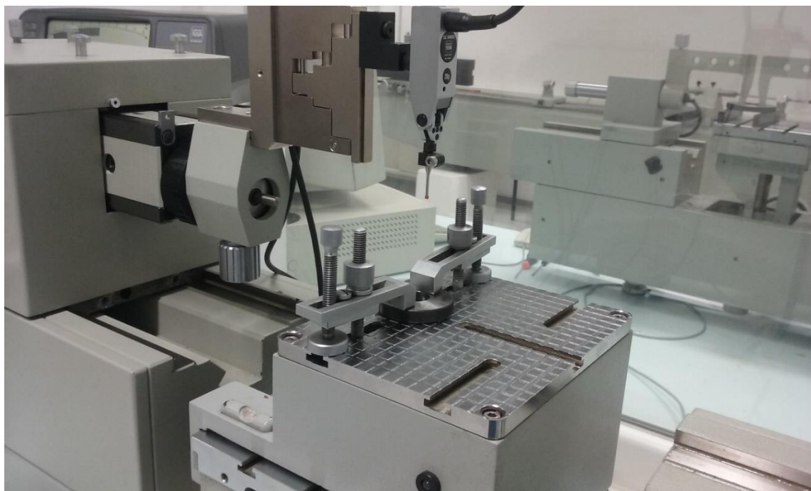
Slika 46. Pozicionirano ticalo iznad unutarnjeg promjera referentnog prstena
