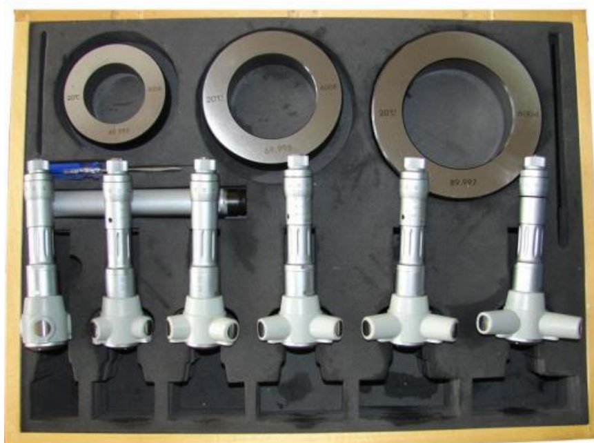
Slika 9. Set trokrakih mikrometara sa pripadajućim komponentama
