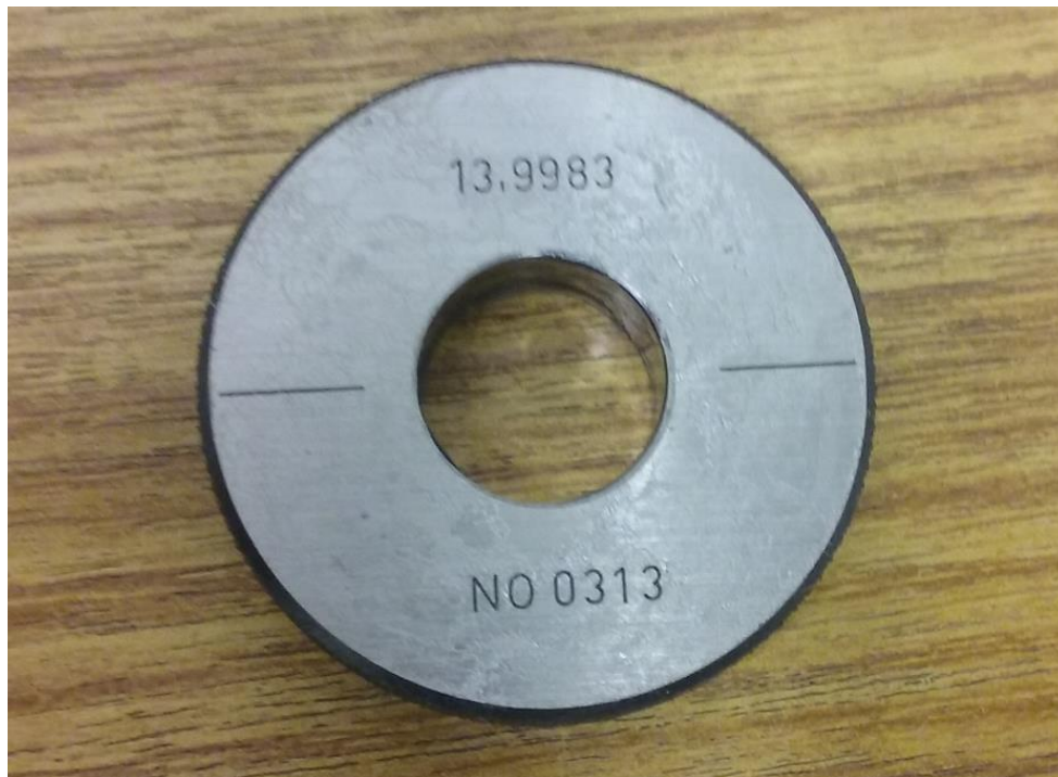
Slika 16. Referentni prsteni Ø13,9983 mm
