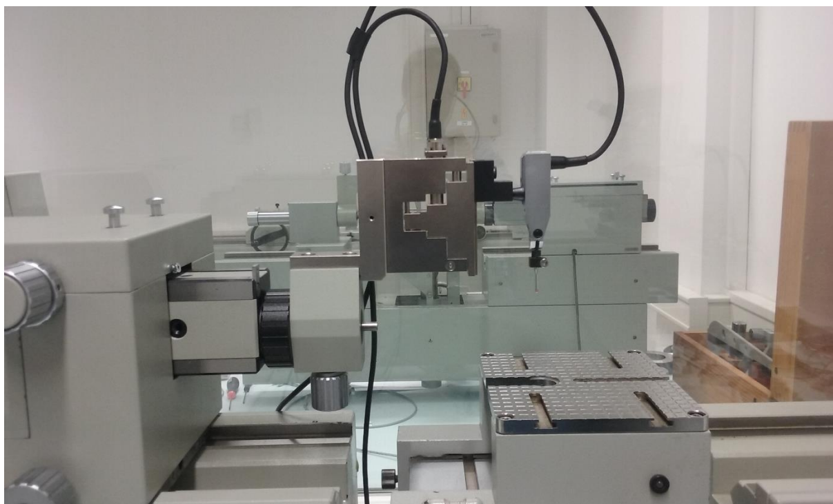
Slika 44. Postavljeni mjerni sustav ticala
