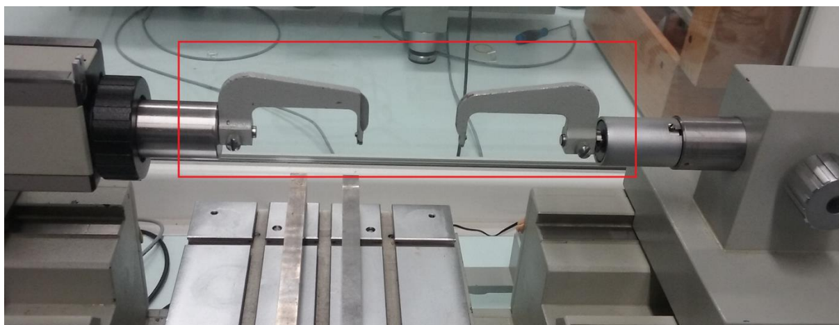
Slika 32. Postavljanje kontaktnih čeljusti
