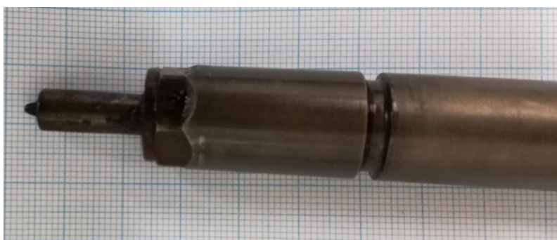
Slika 3. Brizgaljka eksperimentalnog PSA 1.6 HDi dizel motora
