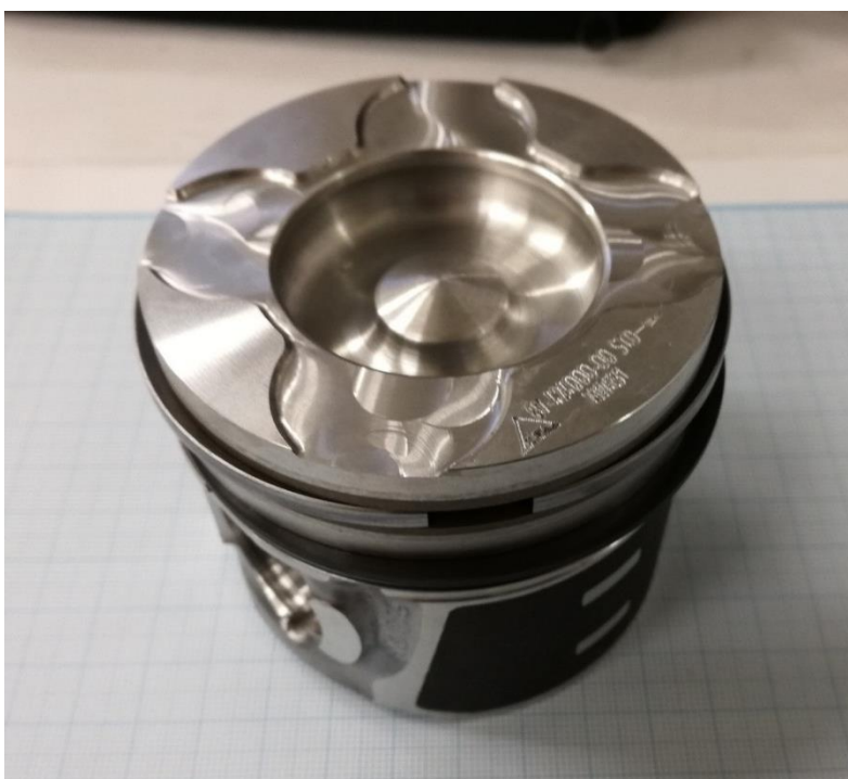
Slika 2. Klip eksperimentalnog PSA 1.6 HDi dizel motora
