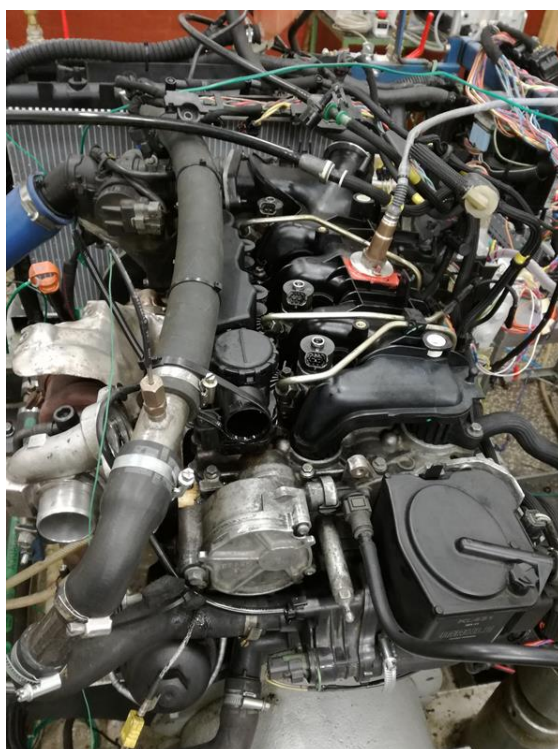
Slika 1. Eksperimentalni PSA 1.6 HDi dizel motor
