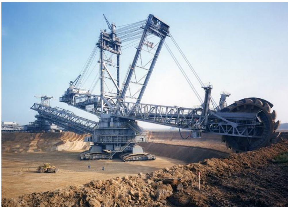
Slika 12. Izuzimač na pogon gusjenicama Krupp Bagger 288
