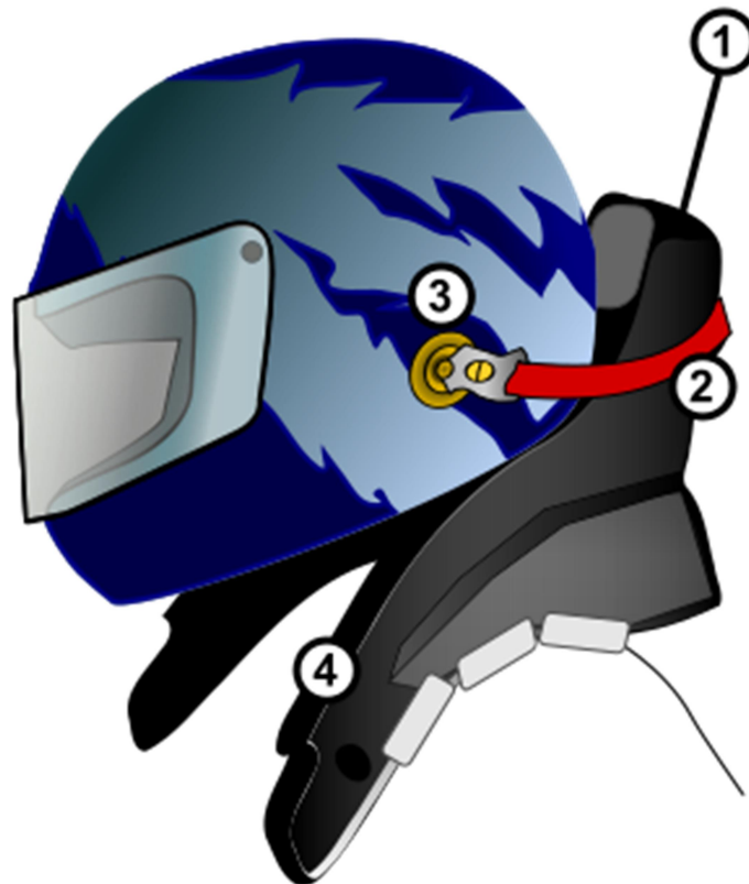
Slika 6. (1) HANS uređaj (2) Remen (3) Pričvršćenje za kacigu vozača (4) Oslonac za ramena [2]
