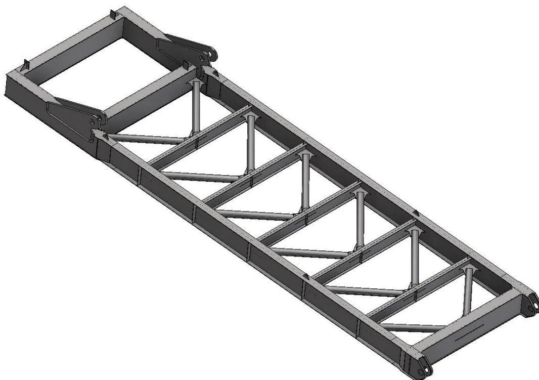
Slika 20. Čelična konstrukcija balastnog utega
