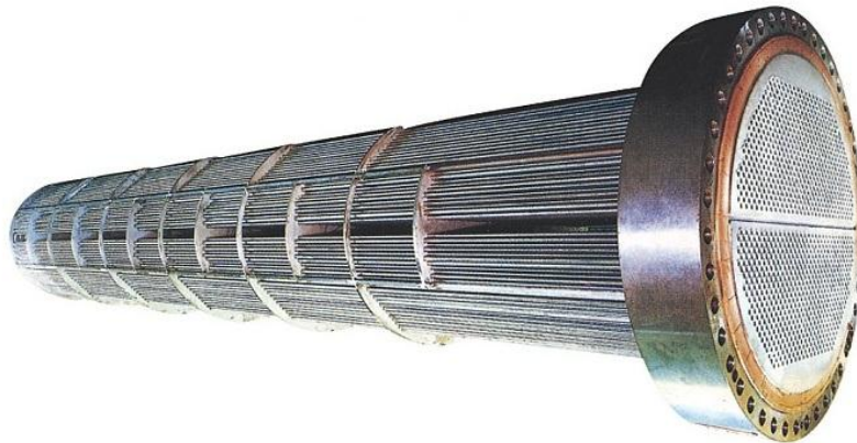
Slika 7. Cijevi parogeneratora spojene s cijevnom stijenom [9]
