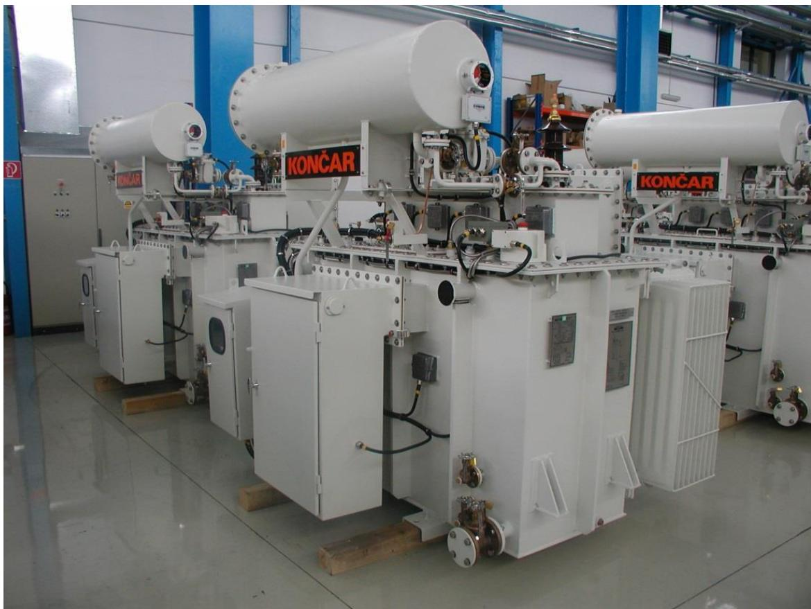
Slika 2.1 Distributivni transformator s kabelskom kutijom[3]
