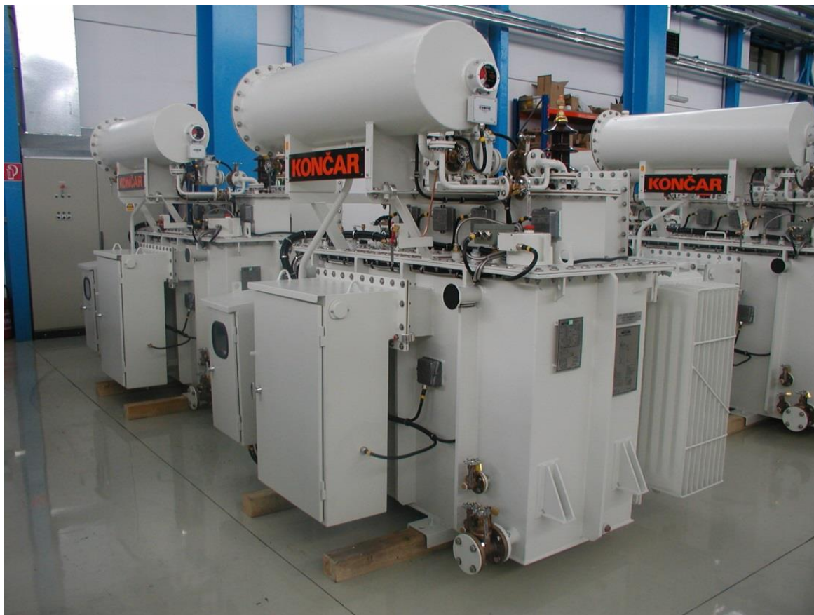
Slika 2.1 Distributivni transformator s kabelskom kutijom[3]
