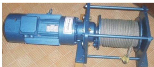
Slika 12. Dizanje pomoću bubnja i čeličnog užeta
