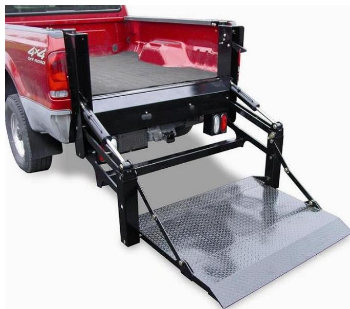
Slika 8. Primjer mehanizma za dizanje
