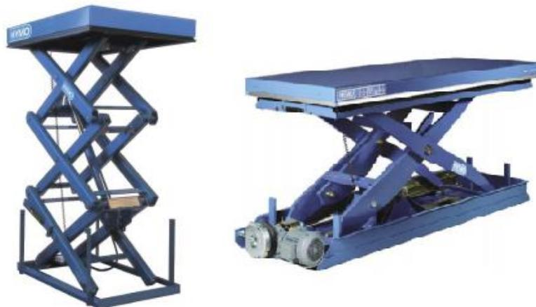
**Slika 10. Primjeri škarastog mehanizma**
