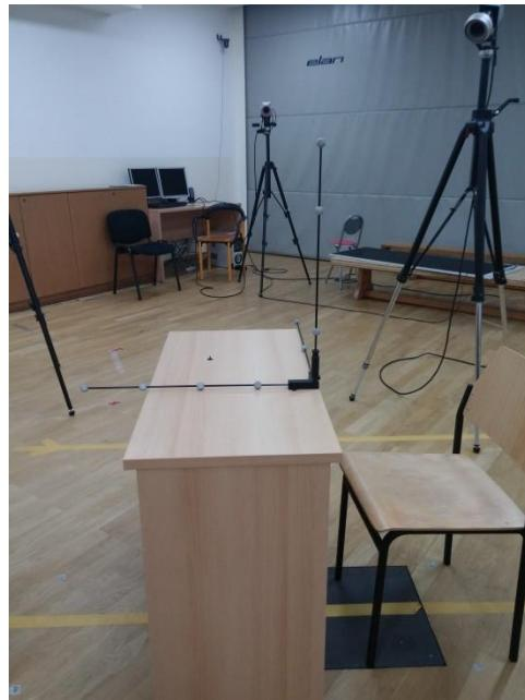
**Slika 20. Određivanje koordinatnog sustava u radnom volumenu**
