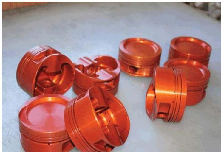
**Slika 20. Aluminijski klipovi obrađeni elektrokemijskom oksidacijom [32]**
