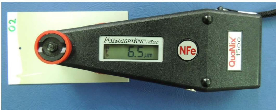
Slika 31. Mjerjenje debljine prevlake pomoću uređaja QuaNix 1500
