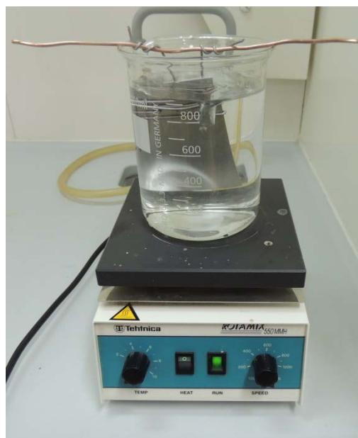
**Slika 30. Ispiranje uzorka na magnetskoj mješalici**
