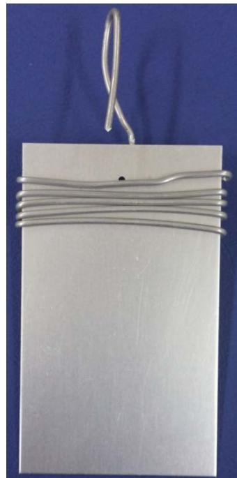
Slika 27. Uzorak pripremljen elektrokemijsku oksidaciju (anodizaciju)
