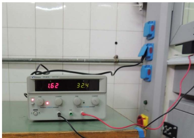
Slika 28. Istosmjerni izvor napajanja
