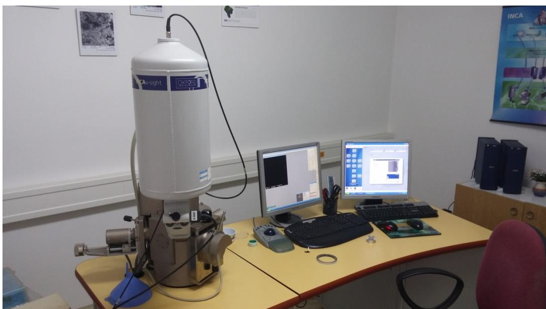
**Slika 32. Elektronski mikroskop Tescan i EDX analizator**
