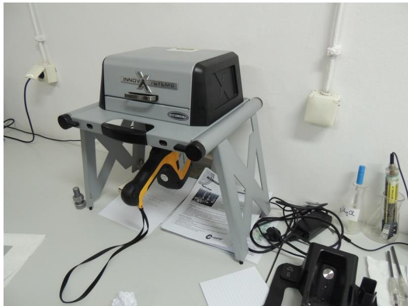
**Slika 21. Određivanje kemijskog sastava pomoću XRF uređaja**
