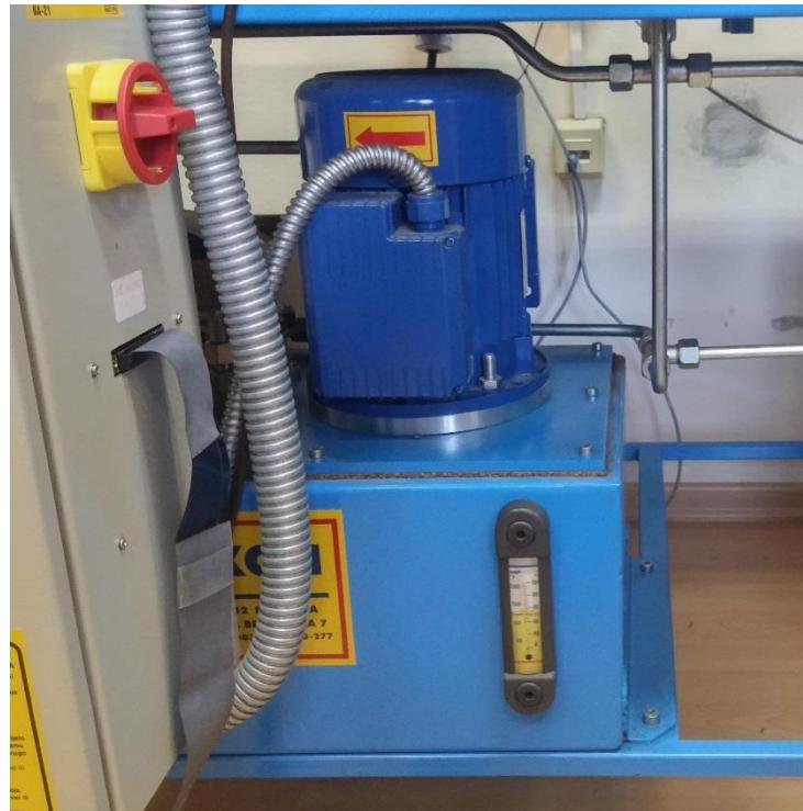
**Slika 3. Spremnik tekućine i hidraulička crpka**
