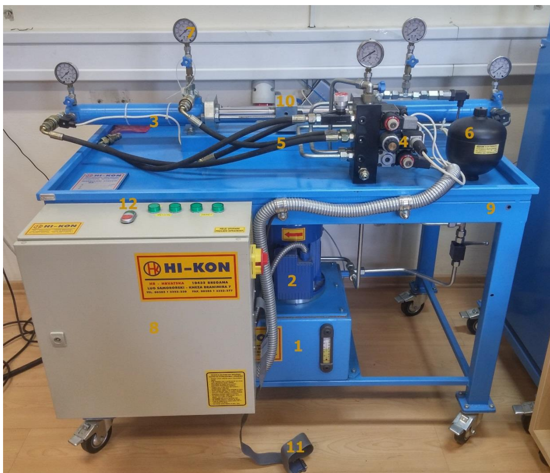
Slika 1. Eksperimentalni elektrohidraulički postav
