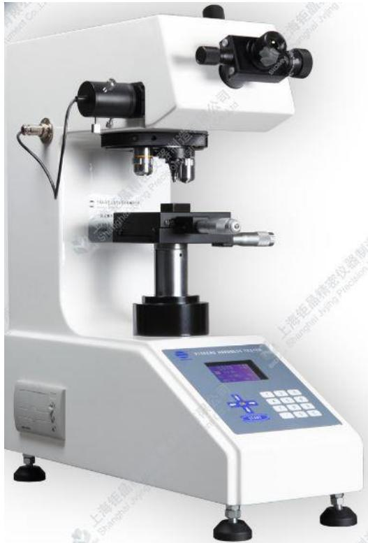
Slika 6. Izgled poluautomatskog uređaja za mjerjenje tvrdoće [7]
