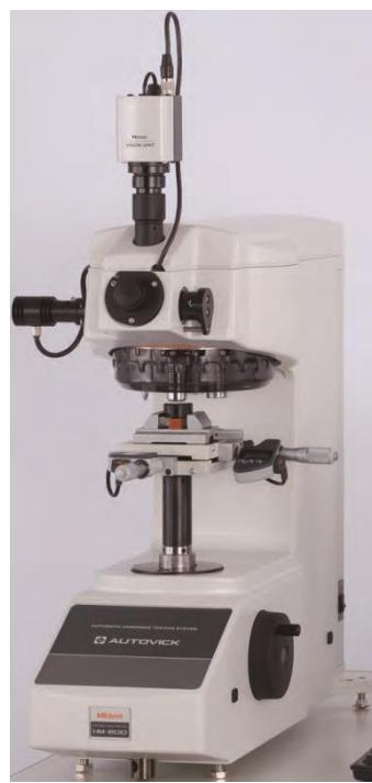
Slika 7. Izgled modernog uređaja za mjerjenje tvrdoće [11]
