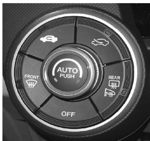
**Slika 16. Rotacijski prekidač klima uređaja [3]**
