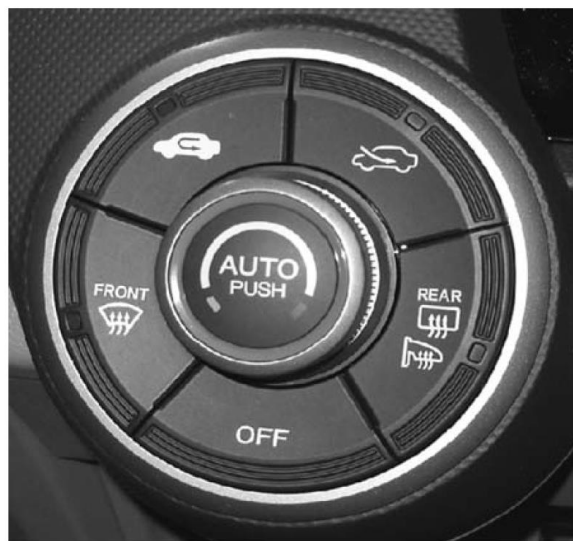
Slika 16. Rotacijski prekidač klima uređaja [3]
