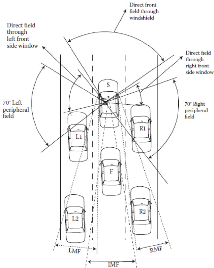
Slika 22. Prikaz sustava vidljivosti 360 stupnjeva [3]
