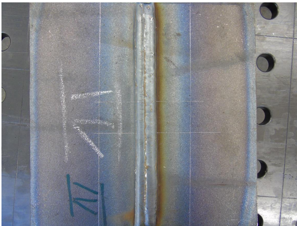
Slika 37. Označavanje ploče za izrezivanje uzoraka
