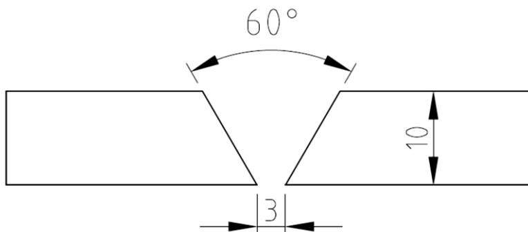
Slika 29. Priprema spoja od  $60^\circ$
