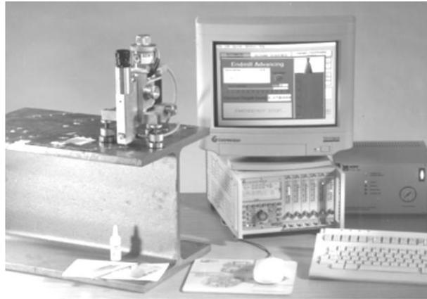
**Slika 19. Oprema za bušenje [14]**
