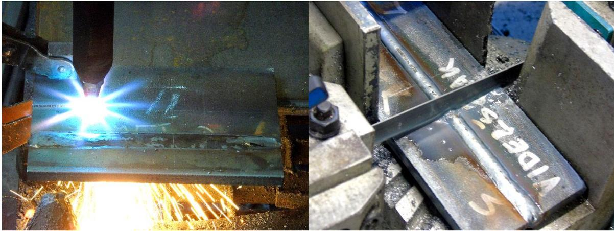
**Slika 38. Izrezivanje uzoraka plinski i tračnom pilom**
