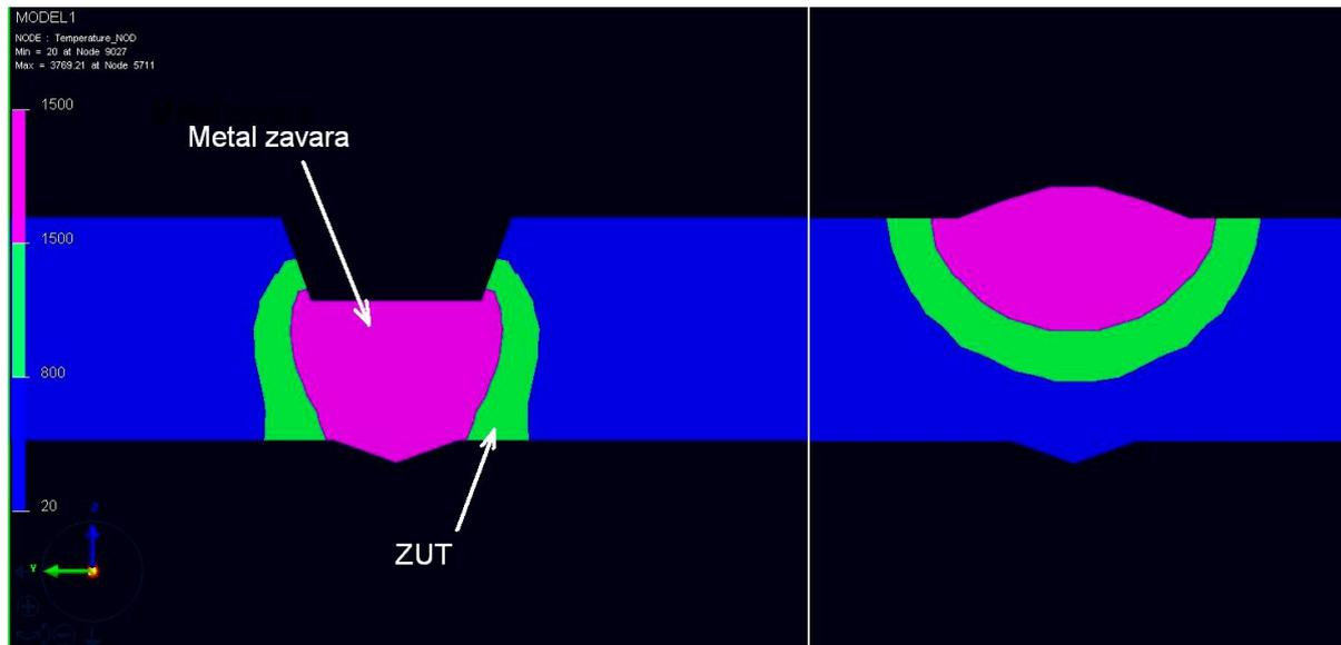
**Slika 45. Kalibracija unosa topline za uzorak 1**
