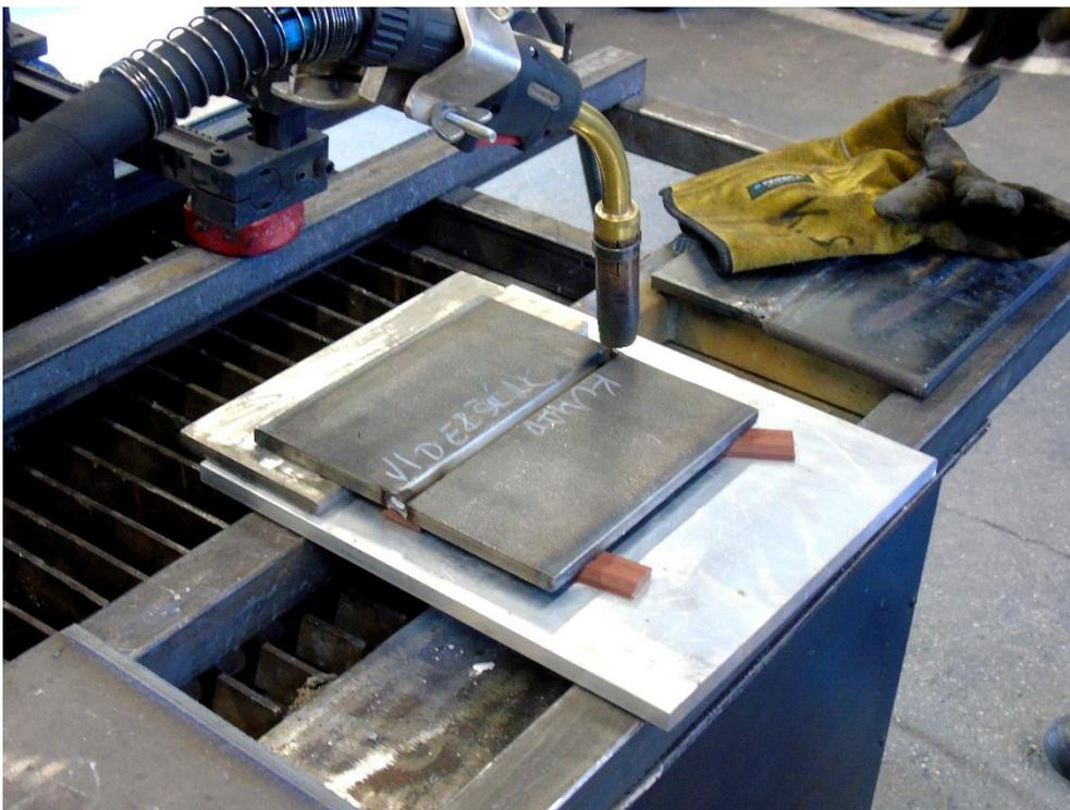
**Slika 33. Pripremljene ploče za zavarivanje**
