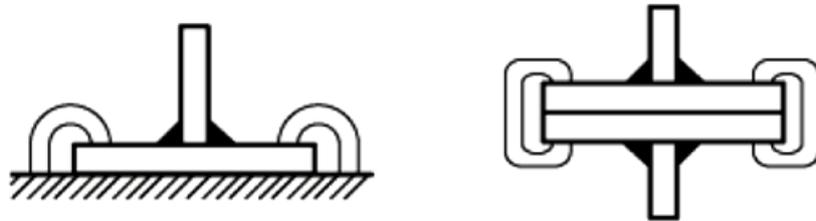
**Slika 13. Primjena steznih naprava [8]**
