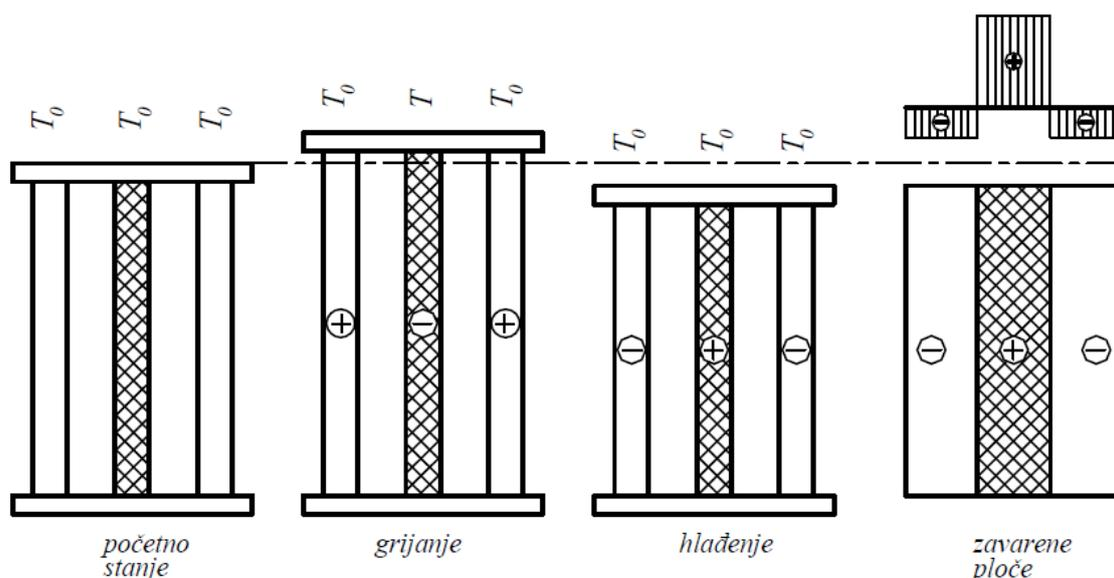
**Slika 5. Pojednostavljeni model nastanka zaostalih napreznja [5]**
