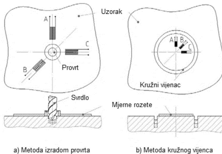
**Slika 20. Shematski prikaz mjerenja metodom bušenja otvora [16]**
