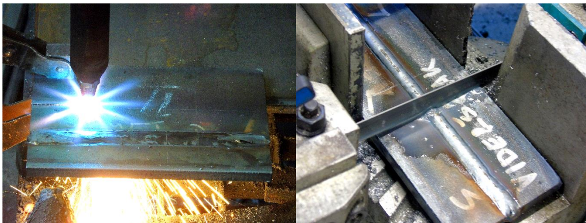
Slika 38. Izrezivanje uzoraka plinski i tračnom pilom
