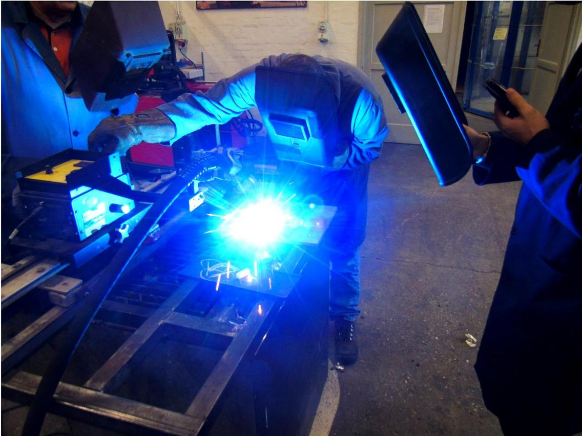
**Slika 34. Zavarivanje uzoraka**
