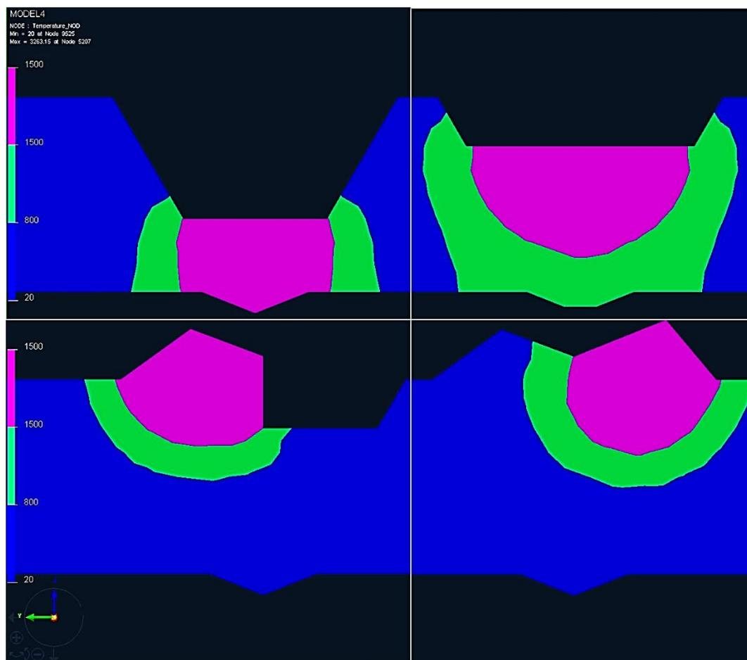
**Slika 54. Kalibracija unosa topline za uzorak 4**
