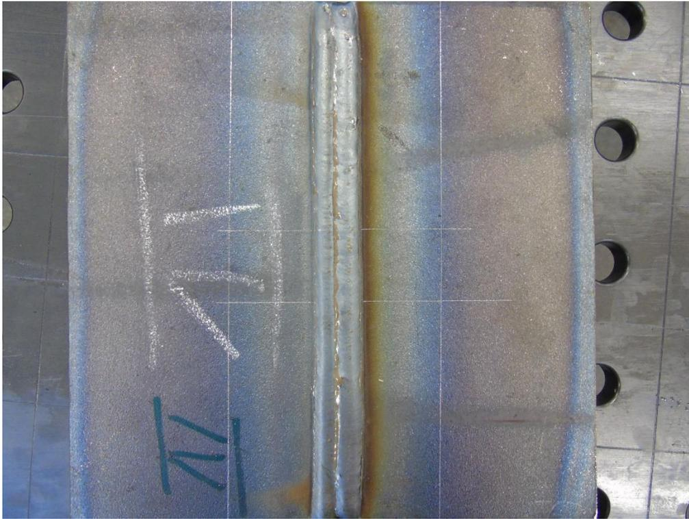
**Slika 37. Označavanje ploče za izrezivanje uzoraka**
