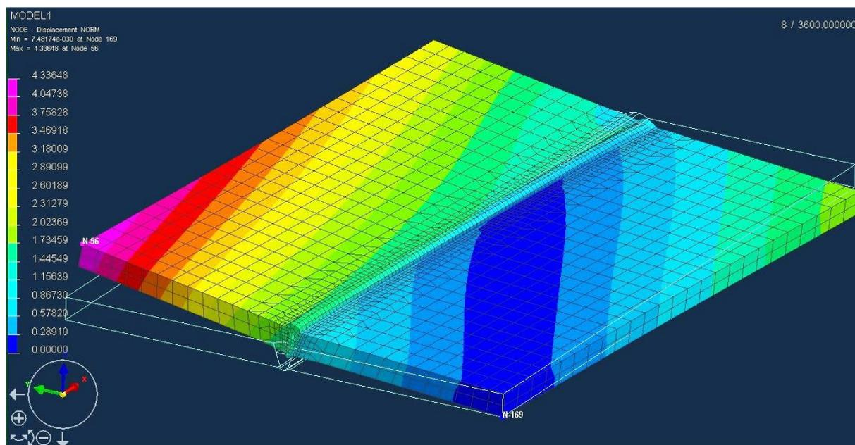
Slika 47. Uvećana deformacija uzorka 1 za 10 puta
