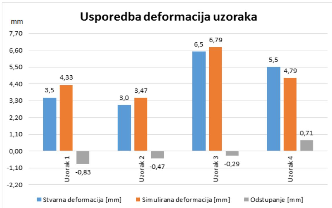
**Slika 57. Usporedba deformacija uzoraka**
