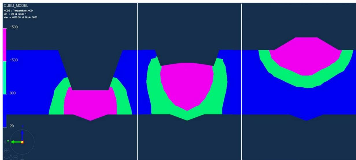
Slika 52. Kalibracija unosa topline za uzorak 3
