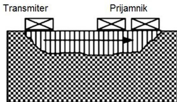
**Slika 22. Shematski prikaz ultrazvučne metode [15]**
