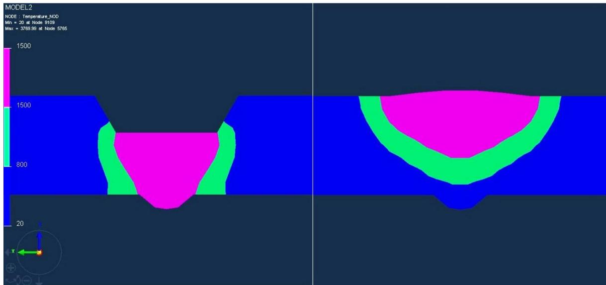
**Slika 50. Kalibracija unosa topline za uzorak 2**
