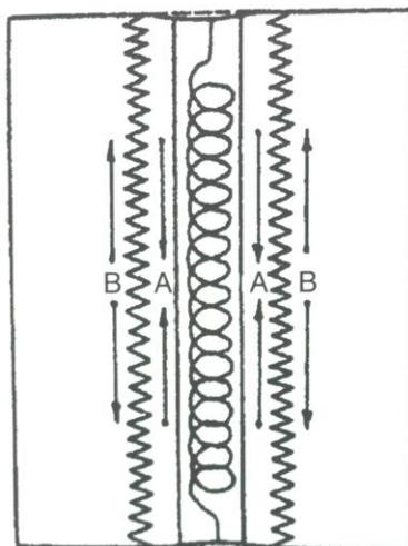
**Slika 6. Shematski prikaz napreznja u zavaru [9]**
