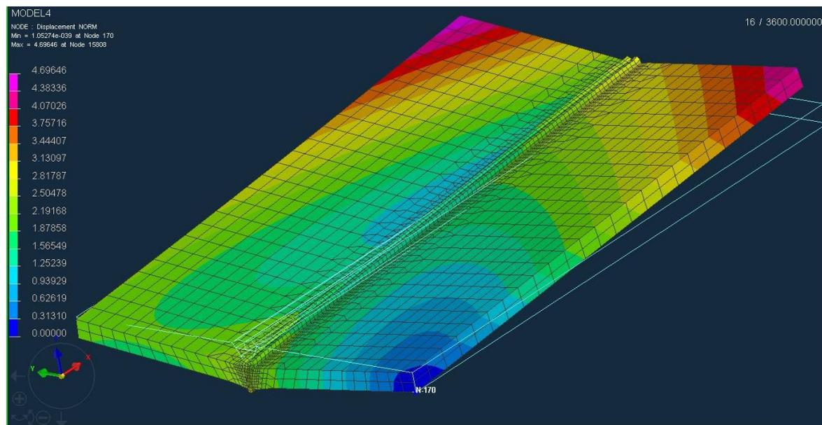
**Slika 56. Deformacija uzorka 4 uvećana za 10 puta**
