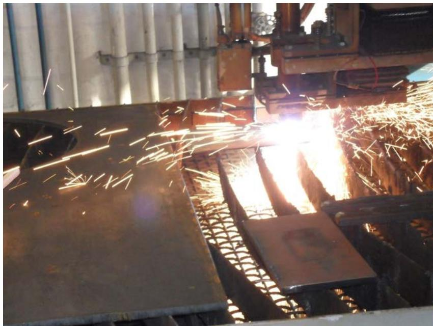
Slika 40. Izrezivanja ploča osnovnog materijala na plazma rezačici
