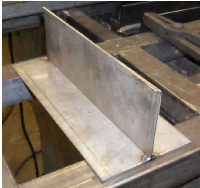
Slika 42. Priprema T-spoja za zavarivanje
