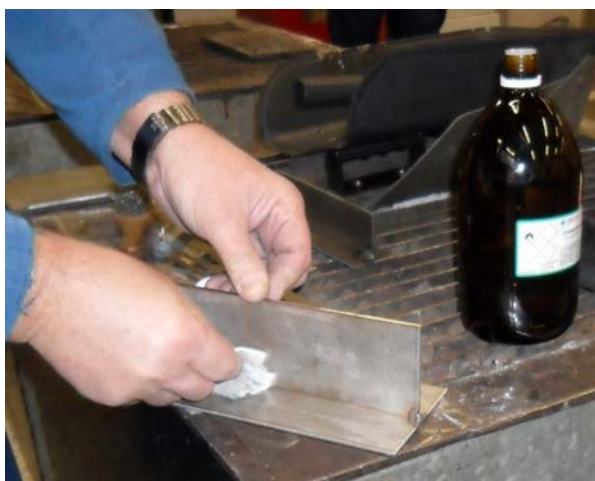
Slika 41. Odmaščivanje osnovnog materijala
