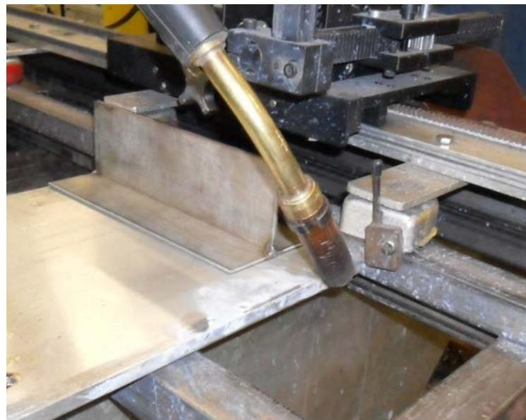
Slika 45. Postav eksperimenta za zavarivanje ispitnog T-spoja
