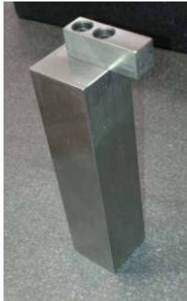
Slika 18. Element za umjeravanje ticala visinomjera
