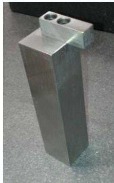
**Slika 18. Element za umjeravanje ticala visinomjera**
