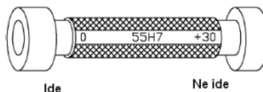
Slika 2. Kalibar za kontrolu unutarnjih mjera
