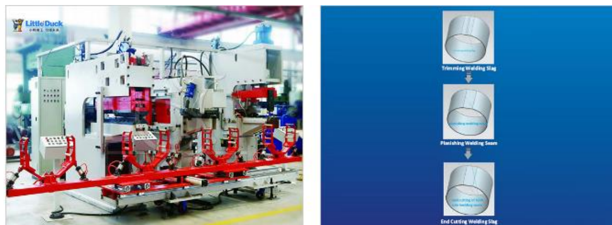
Slika 4.4 Podrezivanje, poravnavanje, obrezivanje [17]
