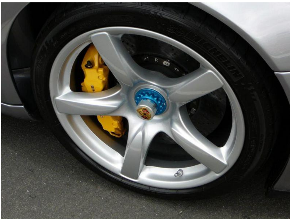
Slika 4.15 Naplatak od magnezijske legure za Porsche Carreru GT [22]
