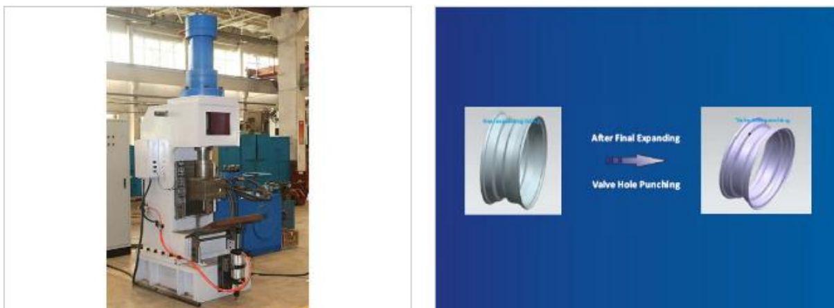
Slika 4.8 Testiranje nepropusnosti plina, probijanje rupe za ventil [17]
