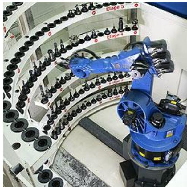
**Slika 9 Slaganje alata na obradnom centru pomoću robota**
