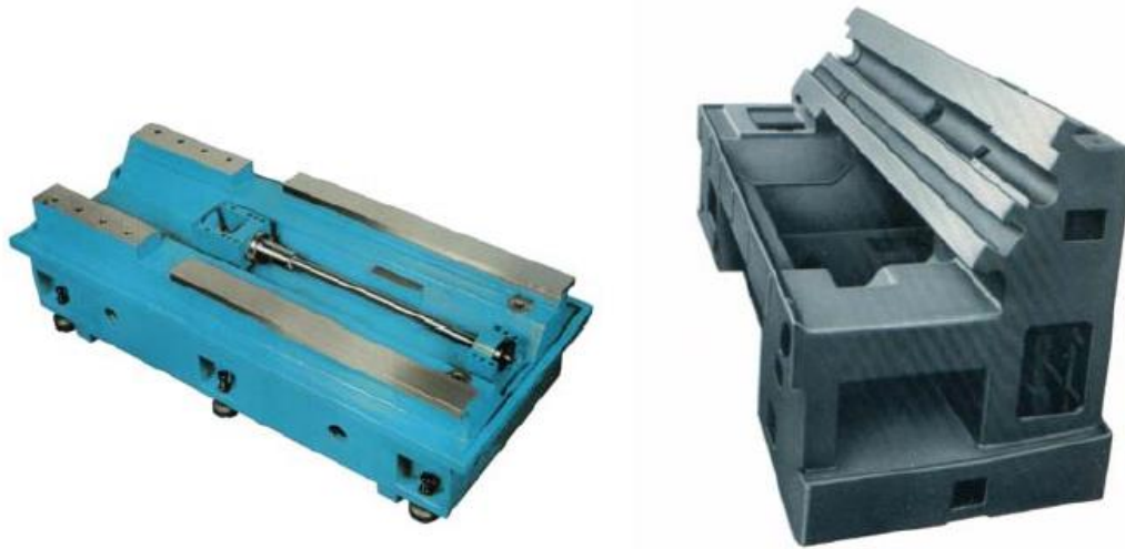
Slika 25 Postolja od sivog lijeva[20]
