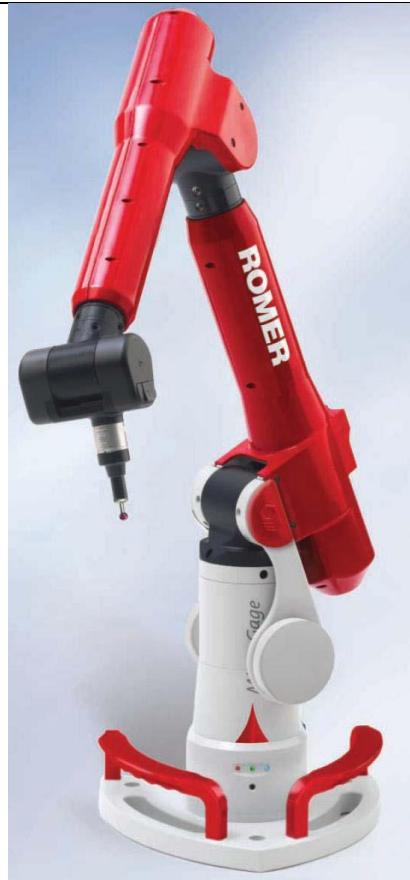
**Slika 14 Robot opremljen ticalom za ispitivanje dimenzija[7]**
