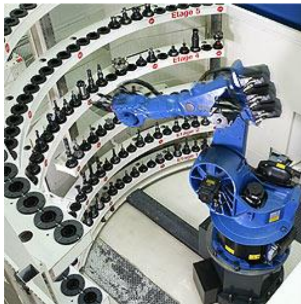
Slika 9 Slaganje alata na obradnom centru pomoću robota
