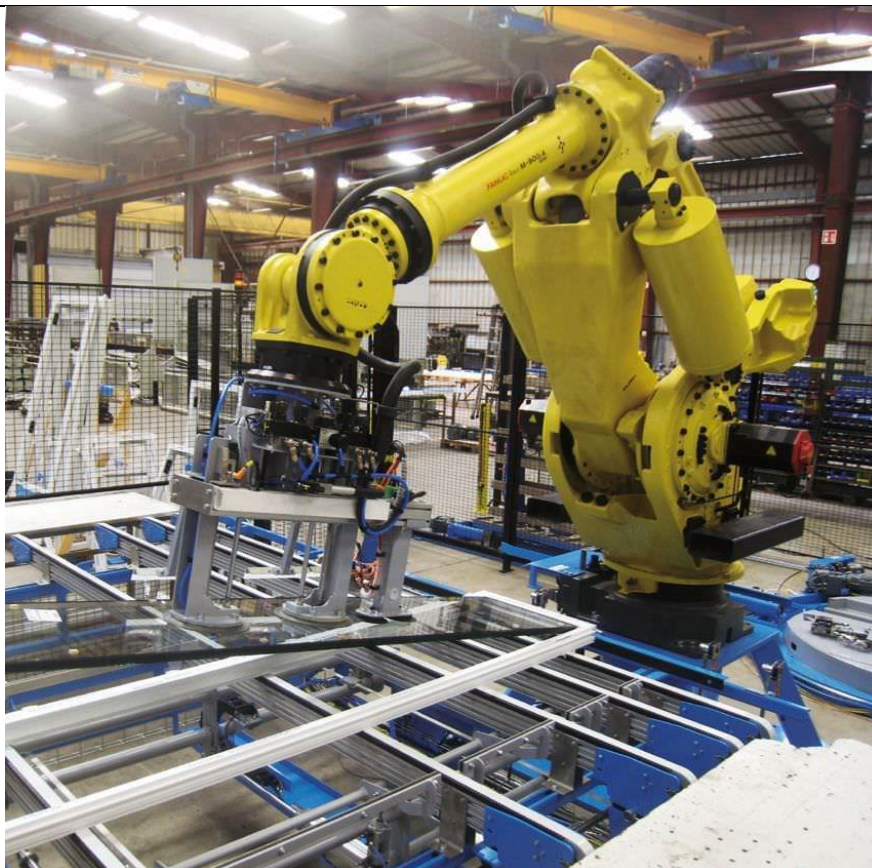
Slika 12 Montaža stakla upotrebom robota [12]
