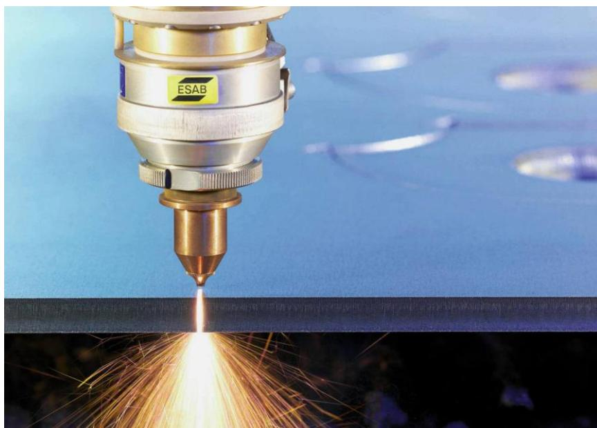
Slika 34 Postupak rezanja laserom
