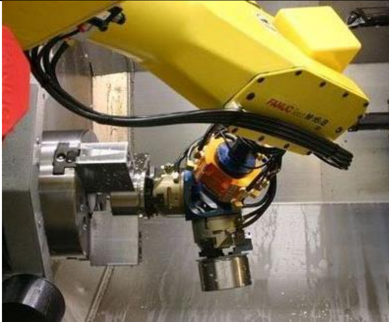
Slika 8 Skidanje izradka s CNC stroja [10]
