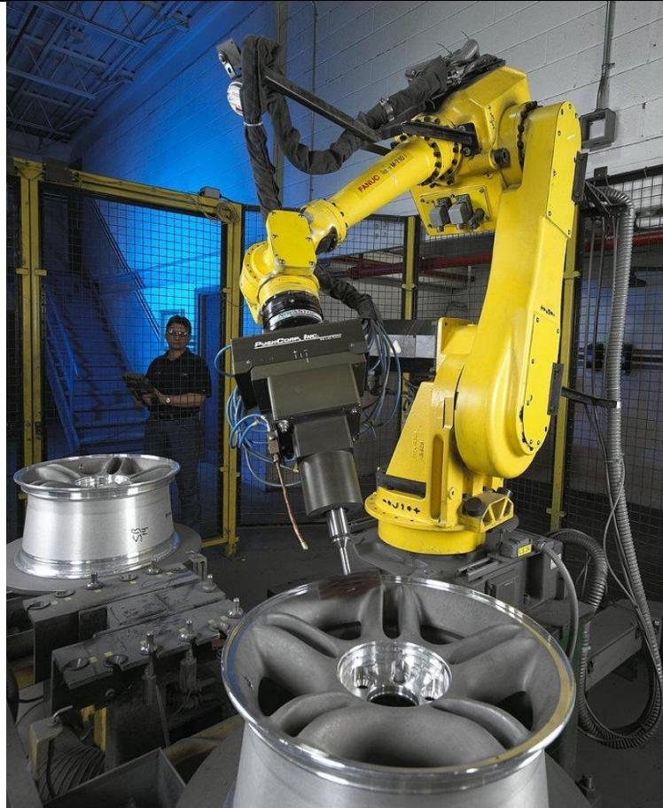
**Slika 11 Robotizirano brušenje**
