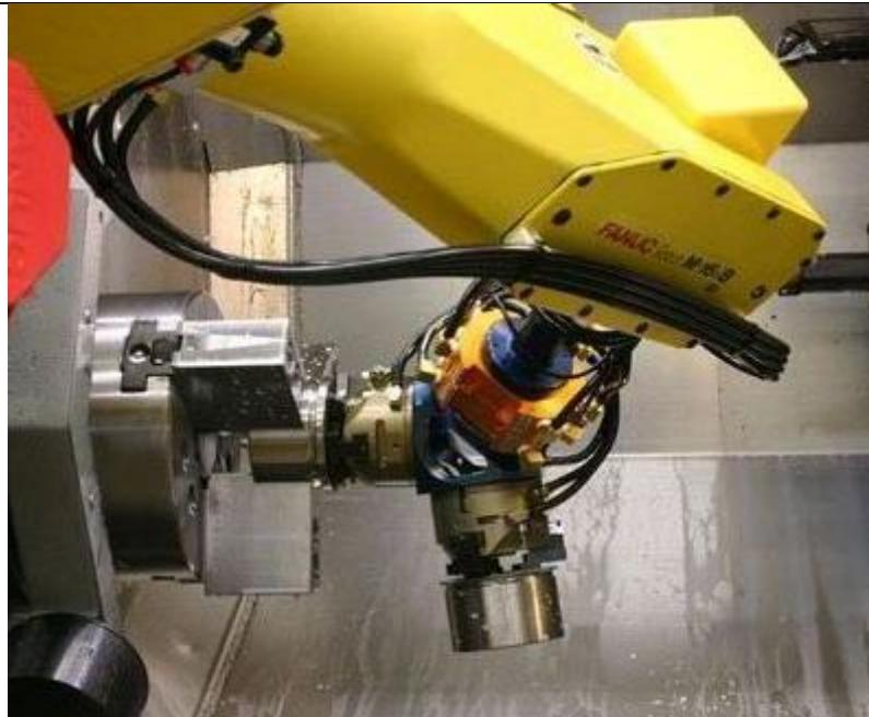
**Slika 8 Skidanje izradka s CNC stroja [10]**
