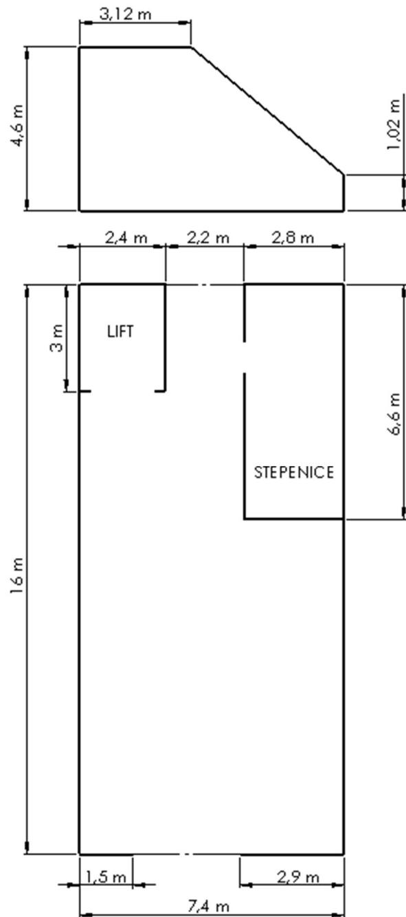
Slika 4. Novo skladište gotove robe, presjek i tlocrt
