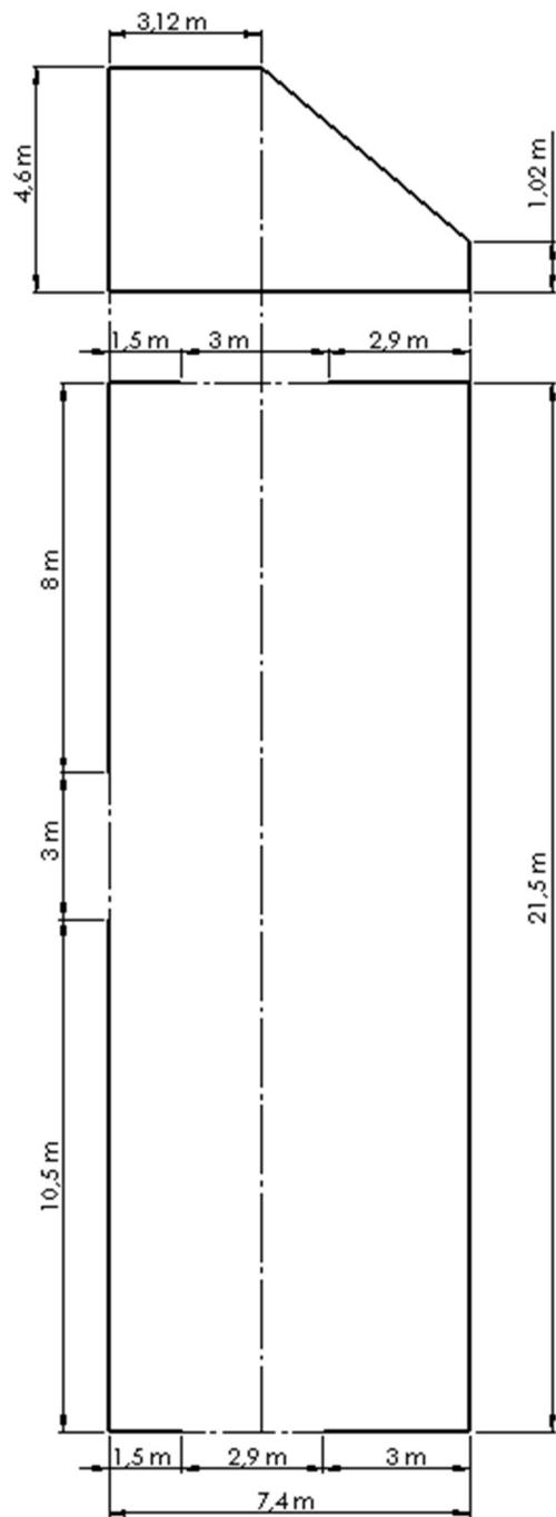
**Slika 5. Novo skladište sirovina, presjek i tlocrt**
