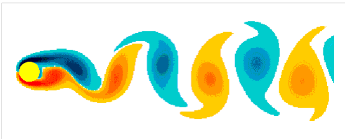
Slika 4.1. Uzorak odvajanja vrtloga
