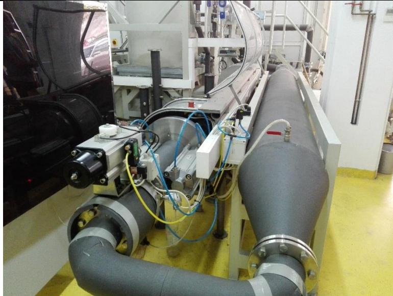
Slika 24. Ispitna klupa sa smirivačem protoka
