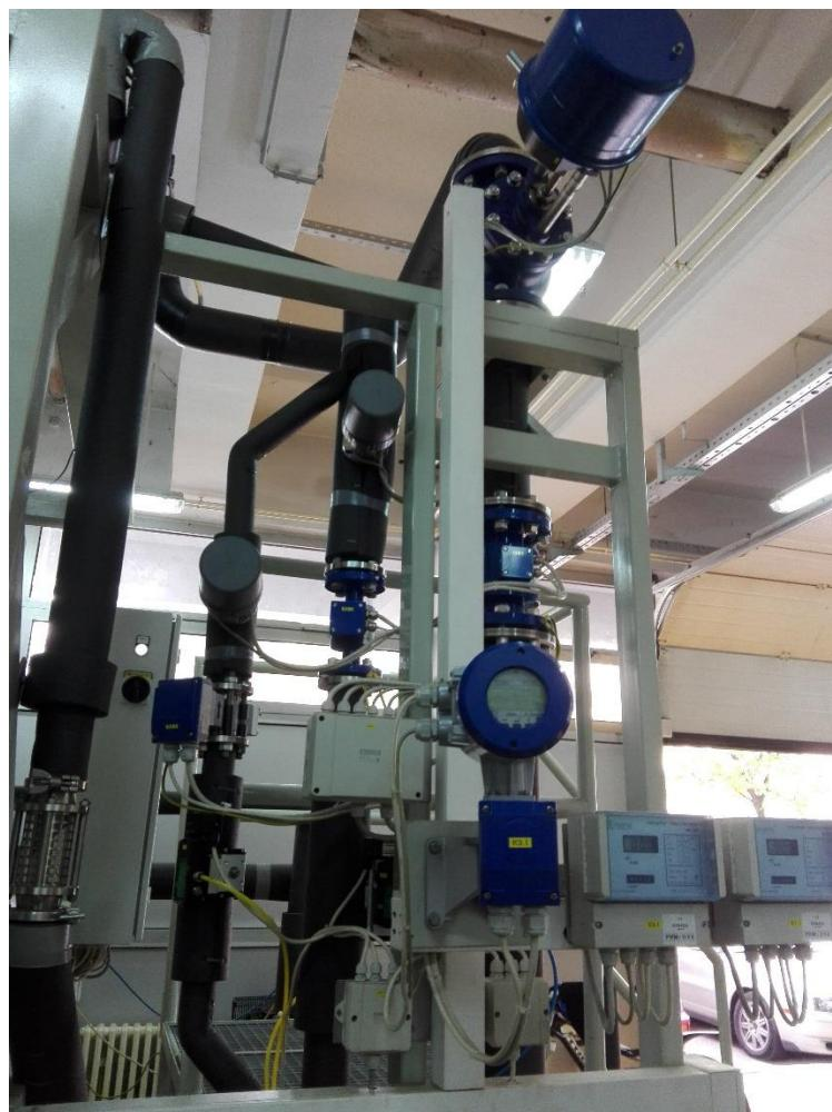
Slika 25. Magnetno induktivna mjerila protoka (MID)
