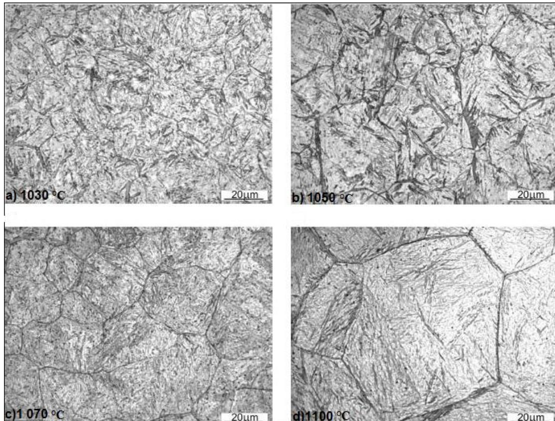
**Slika 8. Mikrostruktura nakon kaljenja obzirom na različite temperature gašenja [6]**
