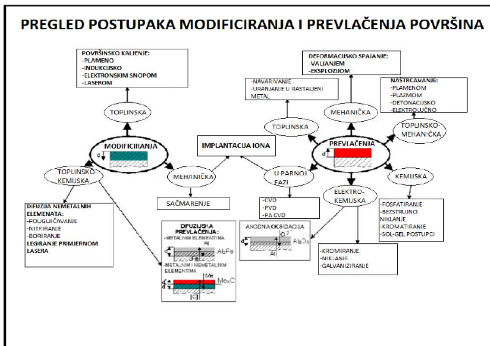
Slika 16. Shematski prikaz podjele postupaka površinske obrade [17]
