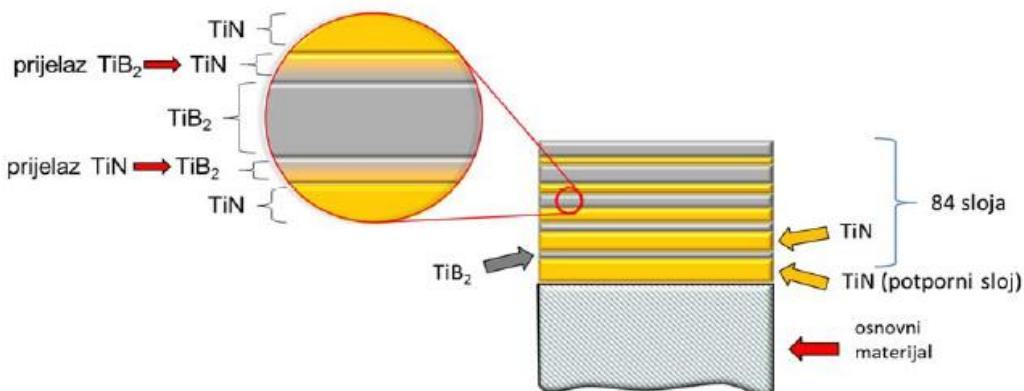
**Slika 35. Shematski prikaz TiBN prevlake na uzorku A3 [15]**
