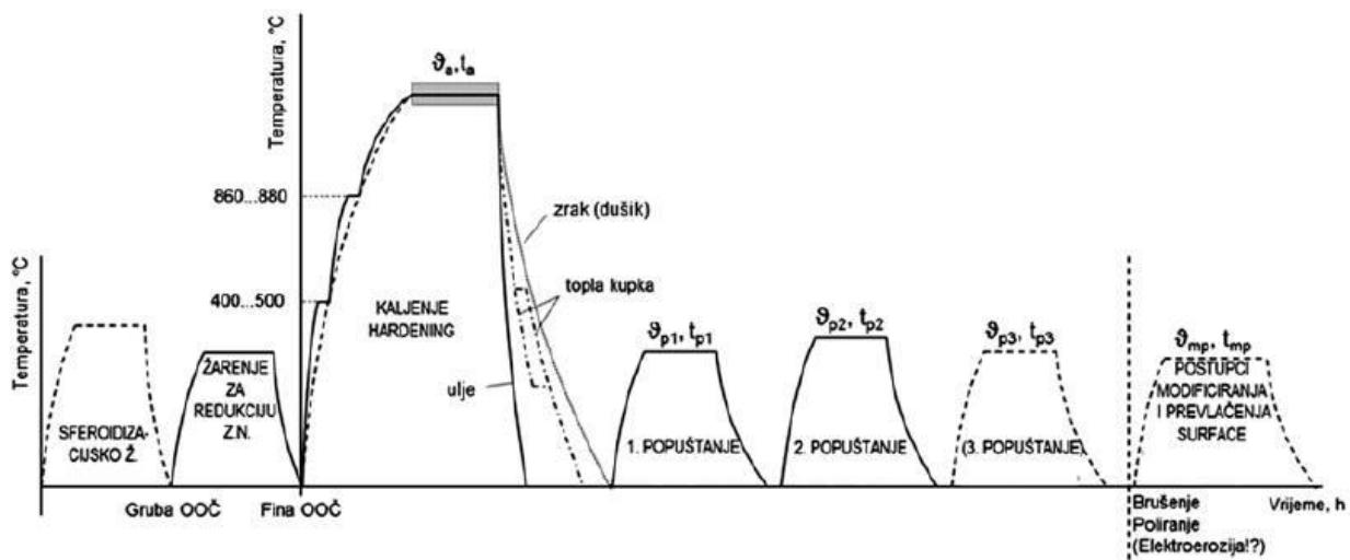
Slika 7. Slijed postupaka toplinske obrade kod alatnih čelika [5]
