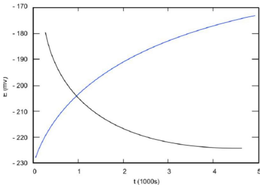
Slika 29. Tipične krivulje kod mjerjenja koroziskog potencijala [17]
