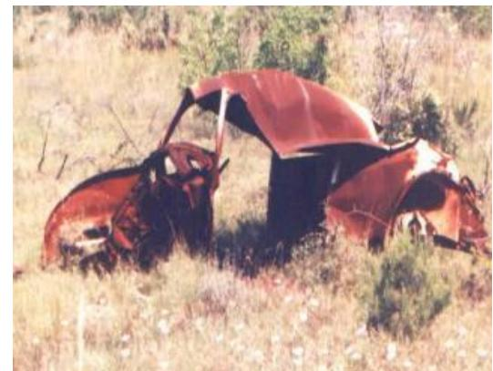
Slika 25. Primjer opće korozije [17]
