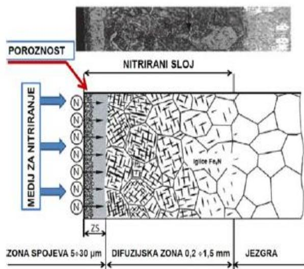
Slika 19. Shematski i stvarni prikaz mikrostrukture nakon nitriranja [9]
