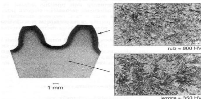
**Slika 14. Primjer različite tvrdoće i mikrostrukture kod zupčnika [16]**
