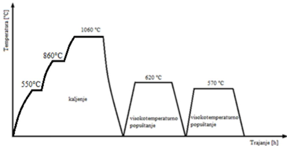
Slika 33. Toplinska obrada čelika X38 CrMoV5-3 [12]
