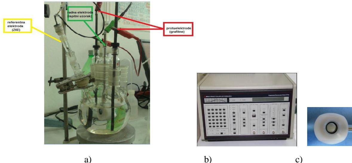
Slika 36. Uredaj za ispitivanje elektrokemijske korozije:
