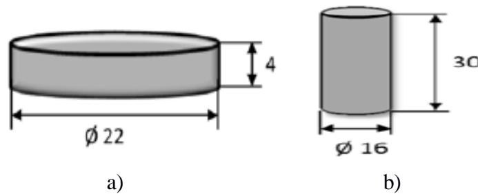
**Slika 32. Uzorci za ispitivanje otpornosti na koroziju [7]:**
