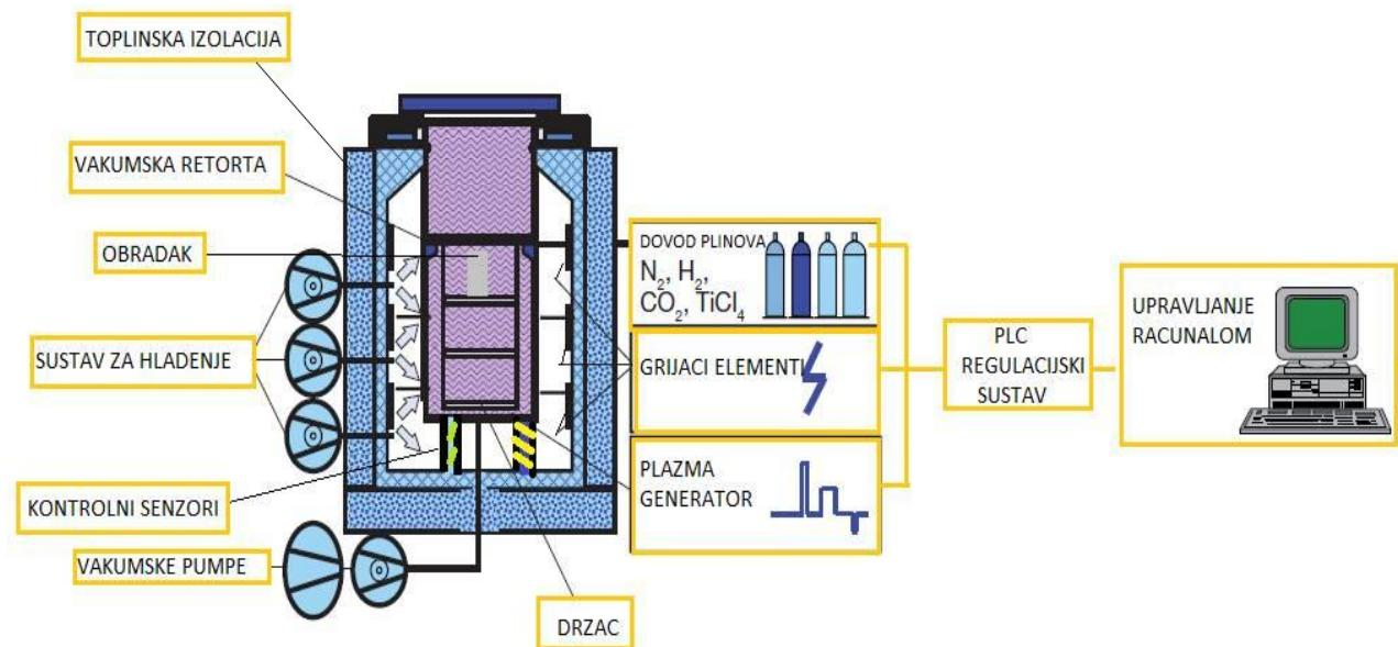
**Slika 22. Shematski prikaz PACVD uređaja [7]**
