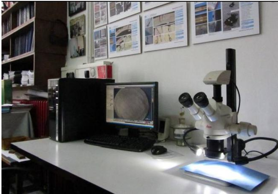
Slika 39. Svjetlosni stereo mikroskop
