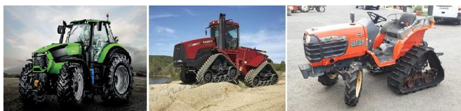
Slika 3. Vrsta podsustava za vožnju kod traktora
