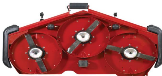
Slika 20. Kosilica s rotacijskim noževima
