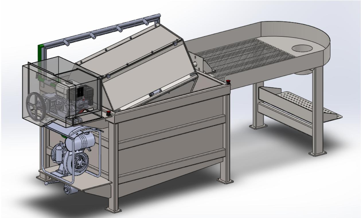
Slika 30: Sklopni model uređaja za čišćenje školjki
