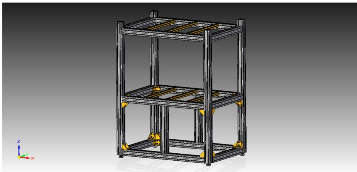
Slika 20. Aluminijska konstrukcija laboratorijskog stola
