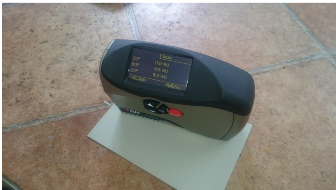
Slika 24. Ispitivanje sjaja uređajem TQC [16]
