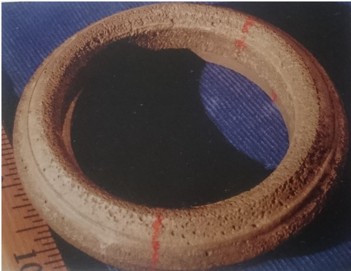
Slika 3. Rupičasta korozija aluminija [5]
