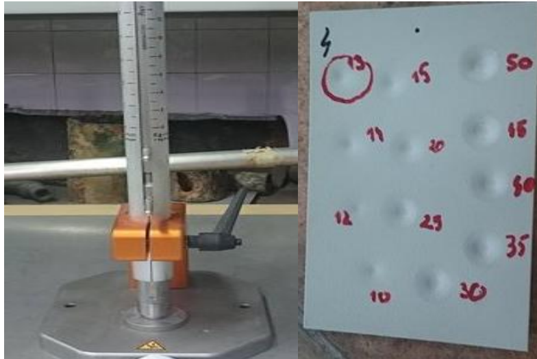
Slika 27. Uređaj za ispitivanje otpornosti na udar i ispitani uzorak
