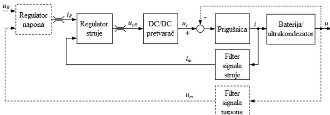
Slika 11 Kaskadni regulacijski sustav baterije/ultrakondezatora
