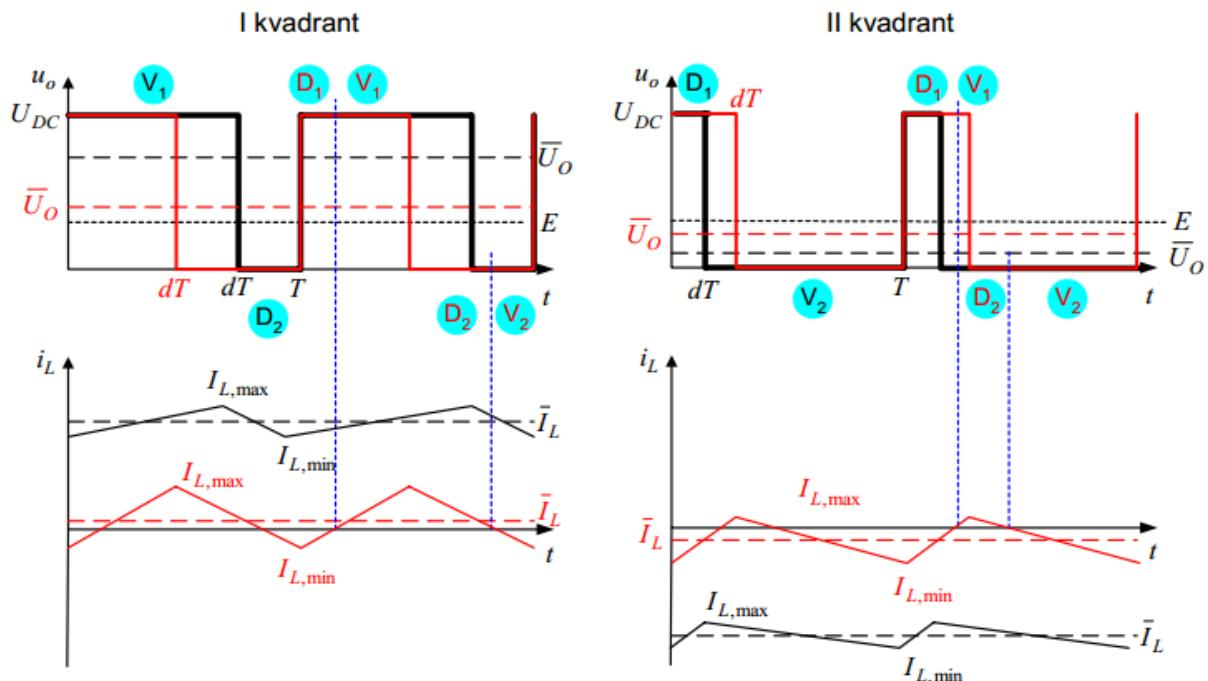
Slika 10 Valni oblici napona i izlazne struje te stanja vođenja komponenata dvo-kvadrantnog pretvarača sa Slikom 9
