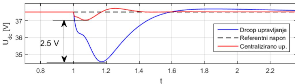
Slika 38 Usporedba naponske „ekskurzije“ droop i centraliziranog upravljanja
