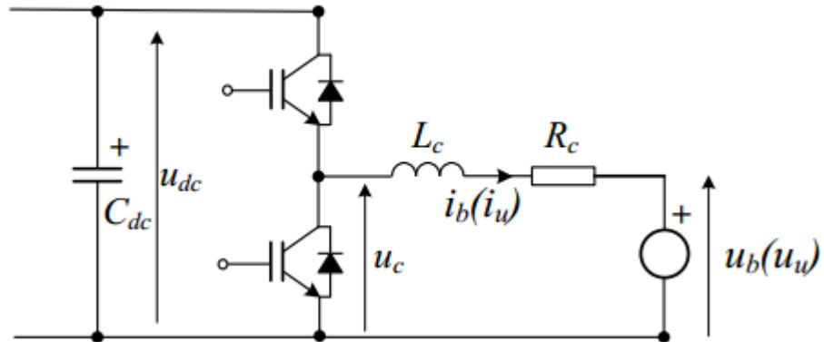
Slika 13 Električna shema pretvarača spojenog na DC sabirnicu
