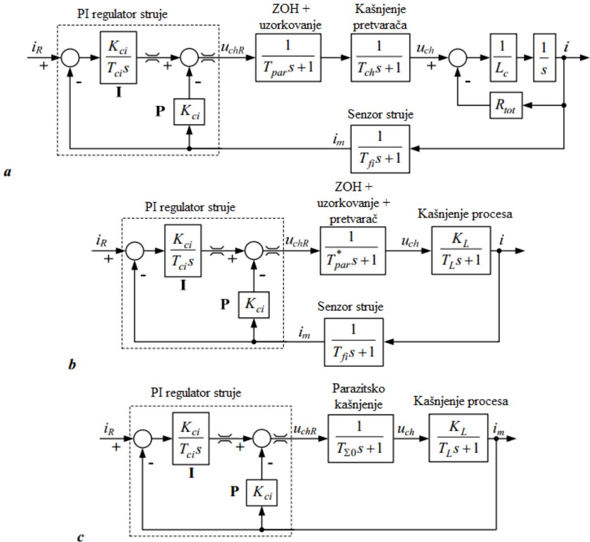
Slika 15 Ekvivalentna regulacijska petlja struje za kvazi-kontinuirani postupak sinteze (a), pojednostavljeni zatvoreni krug s parazitskim kašnjenjem zbog ZOH, uzorkovanja i kašnjenja pretvarača (b), konačni model korišten u dizajniranju regulatora (c)
