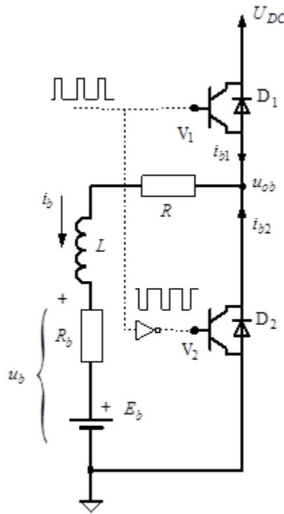
**Slika 9** Shema silazno-uzlaznog pretvarača s istovremenim upravljanjem oba tranzistora
