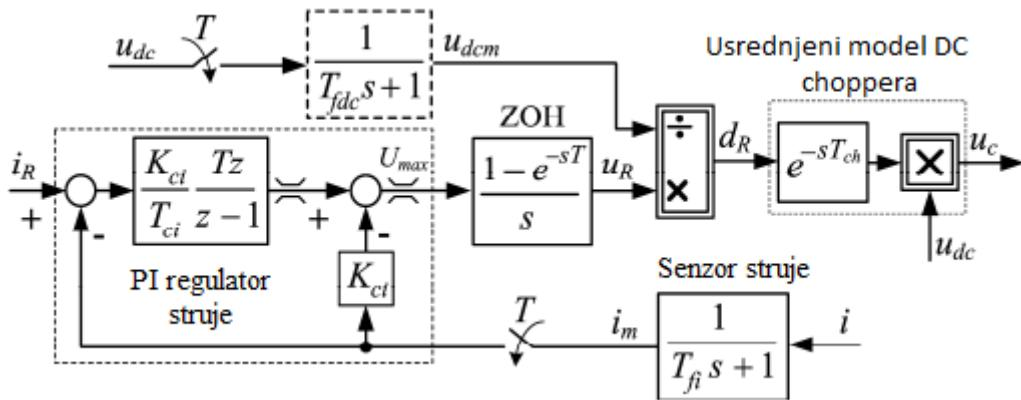
Slika 14 Blok dijagram regulatora struje baterije/ultrakondezatora
