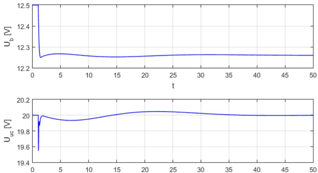
Slika 35 Odzivi napona na stezaljkama baterije i napona ultrakondezatora
