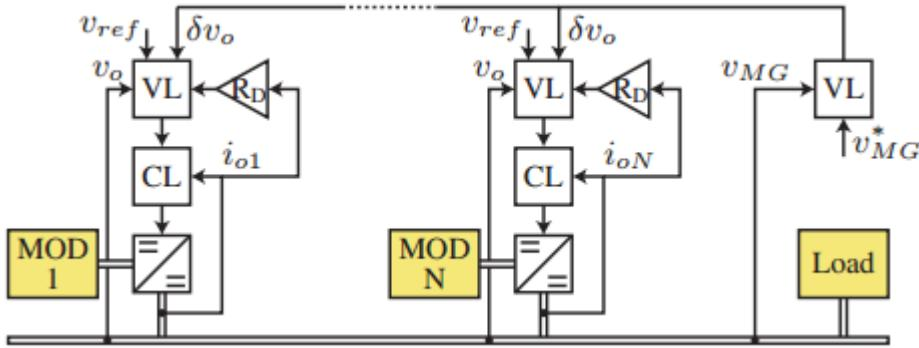
Slika 3 Droop upravljanje DC mikromreže preko virtualnog otpora
