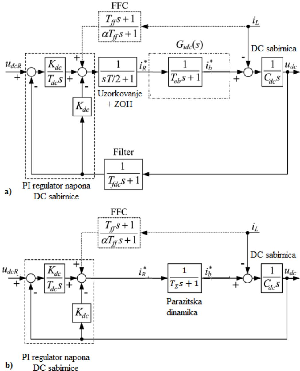
Slika 16 Vremenski-kontinuirani sustav regulacije napona DC sabirnice(a), pojednostavljeni sustav regulacije (b) s unaprijednim kompenzatorom
