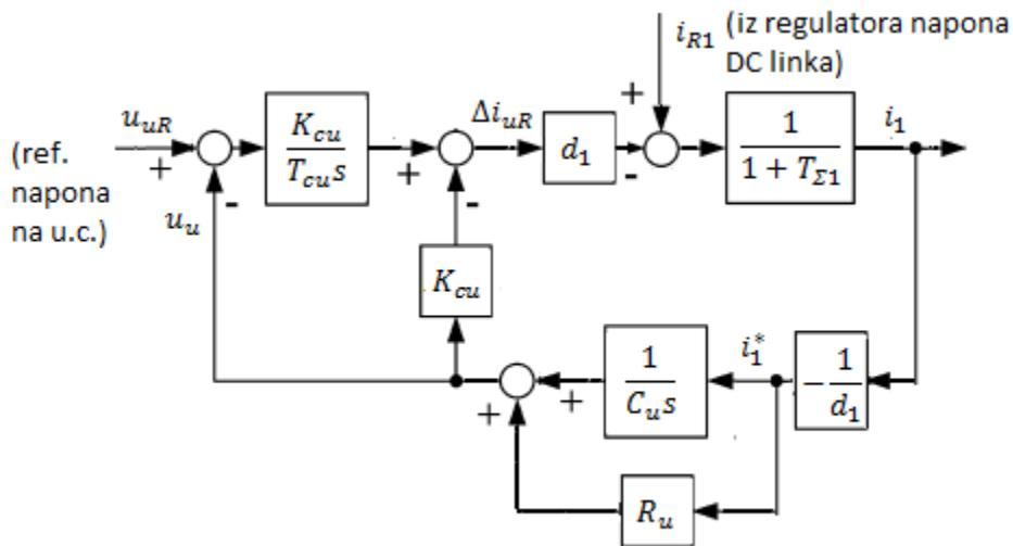
Slika 33 Struktura regulacijskog kruga SoC regulatora ultrakondezatora
