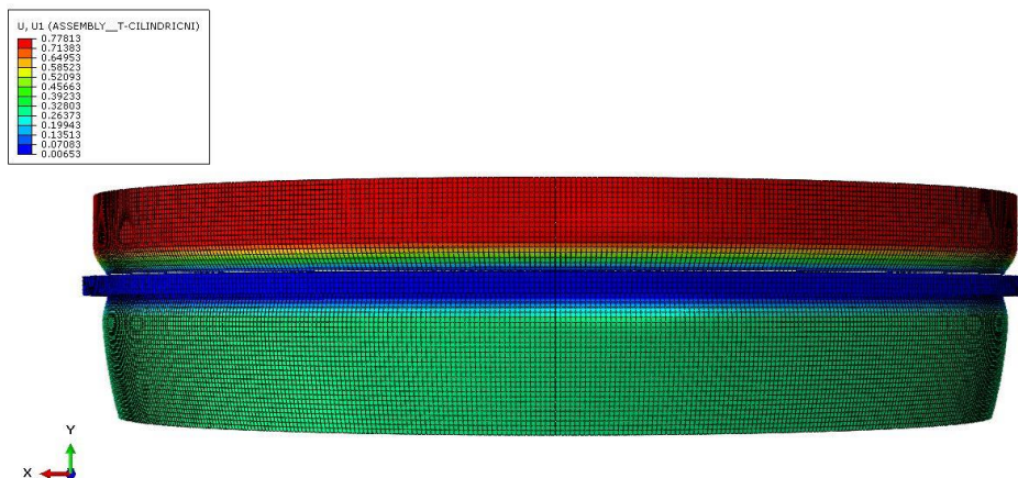
Slika 61. Pomaci podmodela u radijalnome smjeru
