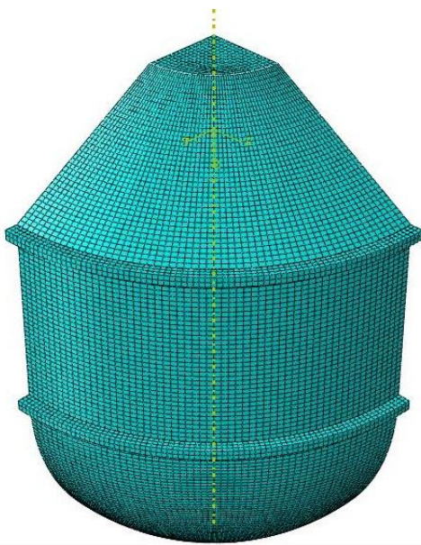
Slika 53. Izgled mreže modela spremnika
