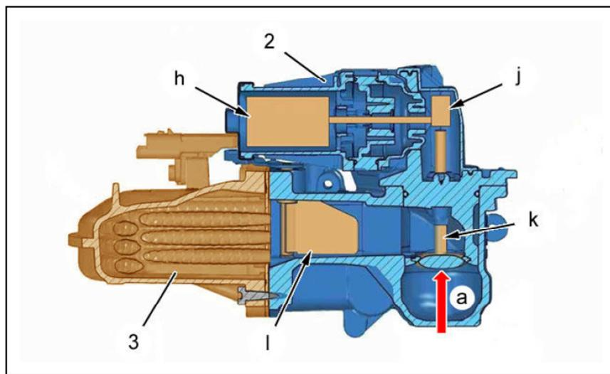
Slika 2.5 Poprečni presjek EGR modula [7]; h – elektromotor, j – krivuljni mehanizam, k – ventil, I – premosna prigušnica, 2 – tijelo EGR venila, 3 - izmjenjivač topline
