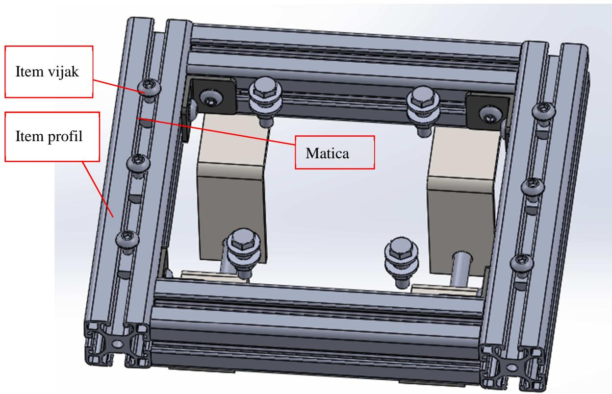
*Slika 5.2 Okvir nosača pumpe*
