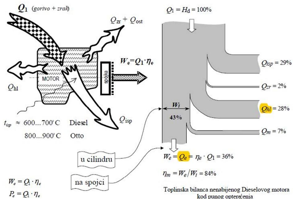
Slika 3.1 Razdioba energije motora prikazana Sankeyjevim dijagramom [4]
