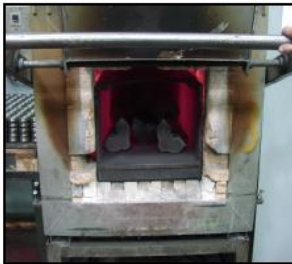
Slika 4. Zagrijevanje kalupa u peći [6]
