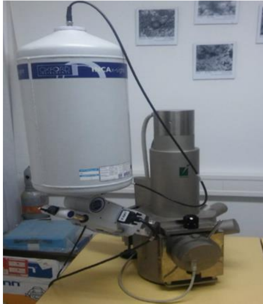
Slika 5.12 Skenirajući elektronski mikroskop „Tescan Vega 5136 FM“
