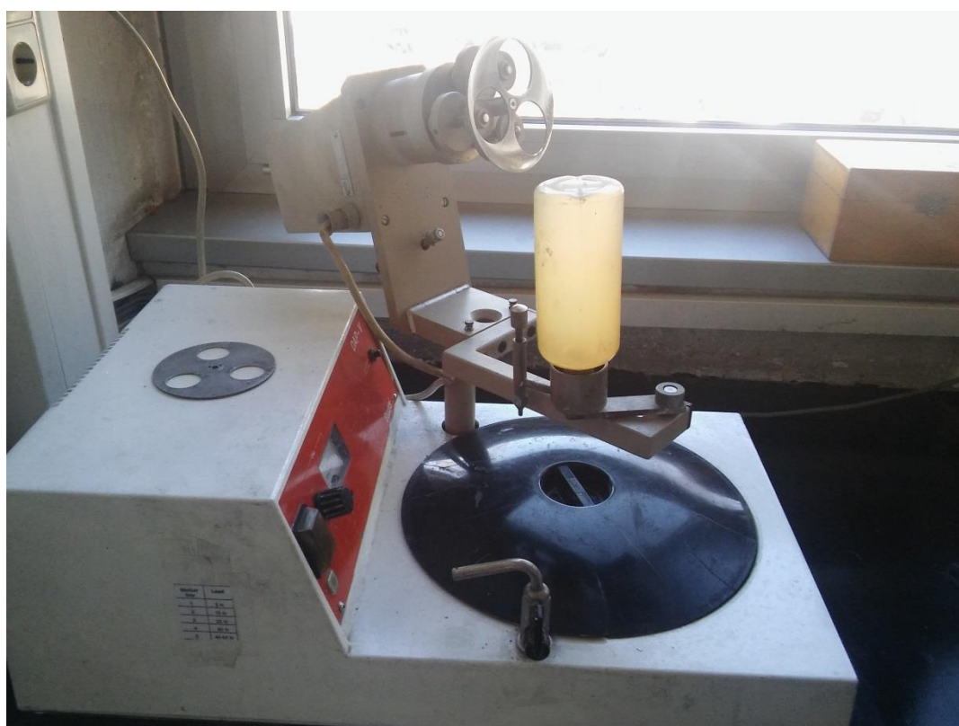
Slika 5.15 Uređaj za poliranje uzorka
