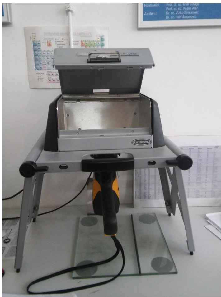
Slika 5.18 Uređaj za rendgensku fluorescentnu analizu, XRF, „Olympus DELTA Family Handheld XRF Analyzers“.
