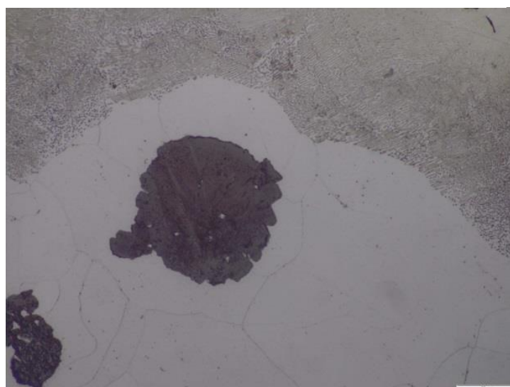
Slika 6.3 Mikrostruktura uzorka od nodularnog lijeva, nagrizeno stanje, najveće povećanje
