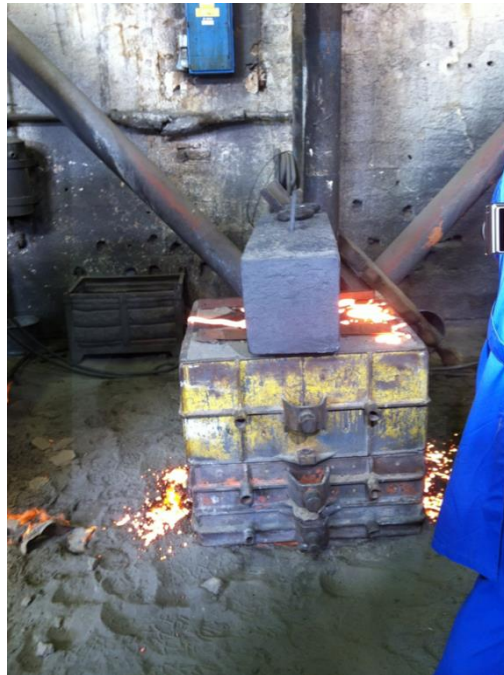
Slika 5.9 Kalup neposredno nakon uljevanja
