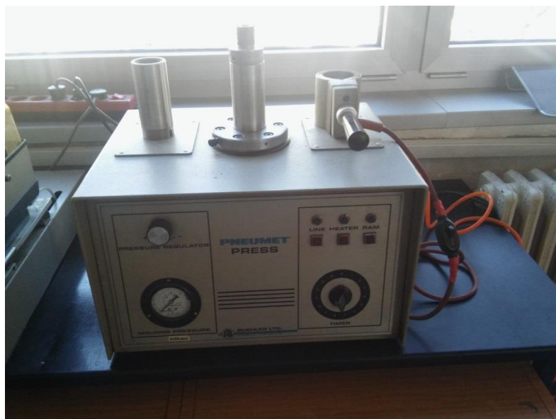
Slika 5.16 Uređaj za izradu kalupa
