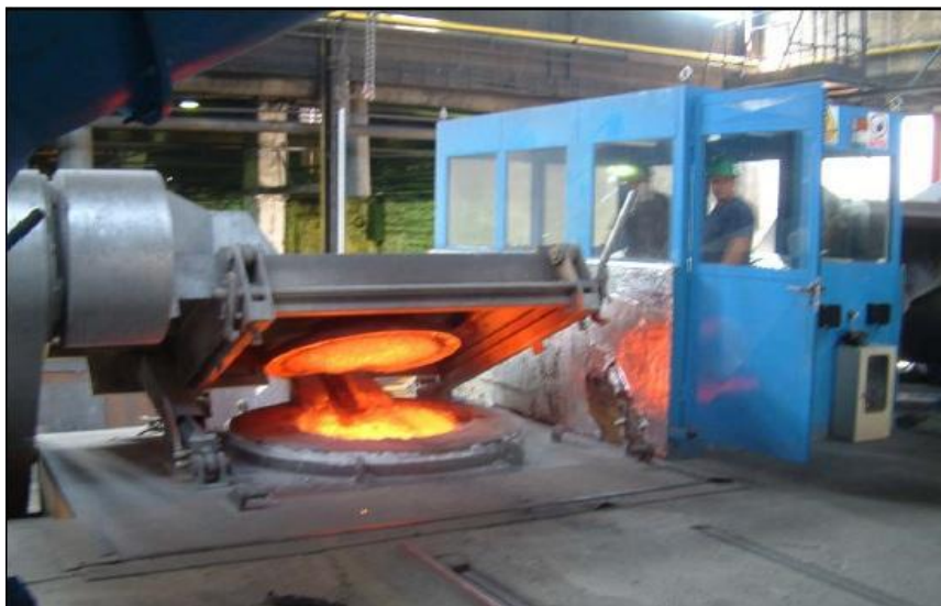
Slika 5.2 Srednje - frekventna indukcijska peć
