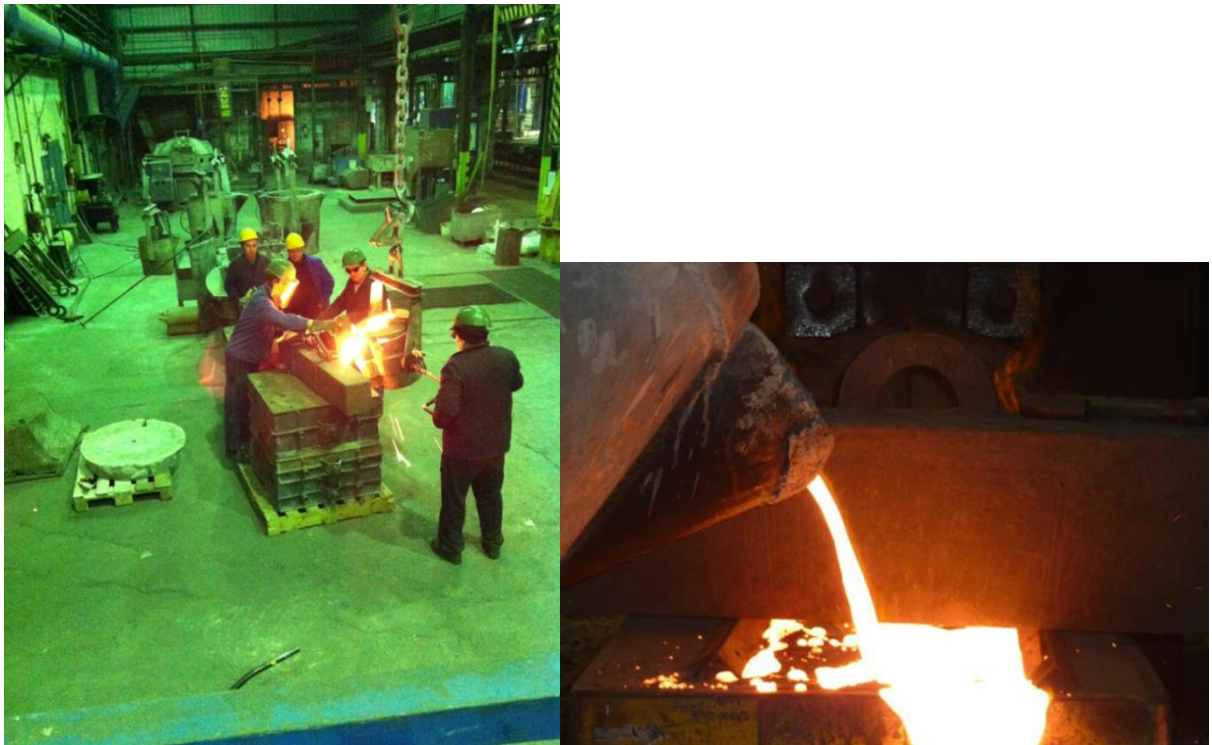
Slika 5.8 Prenošenje taljevine u loncu i ulijevanje u pješčani kalup
