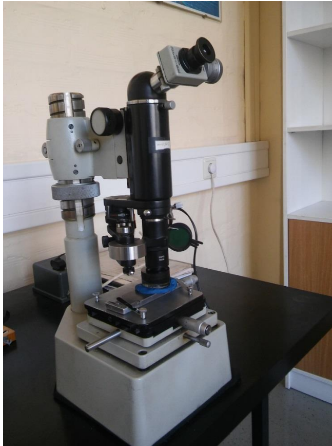
Slika 5.17 Uređaj za ispitivanje mikrotvrdoće
