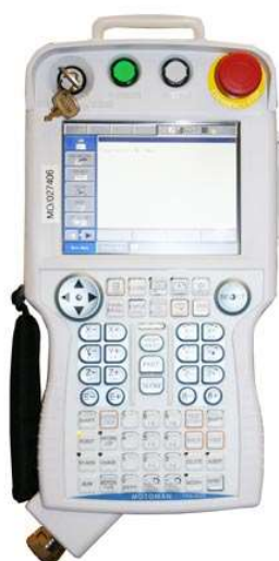
Slika 30 DX100 upravljački privjesak [19]
