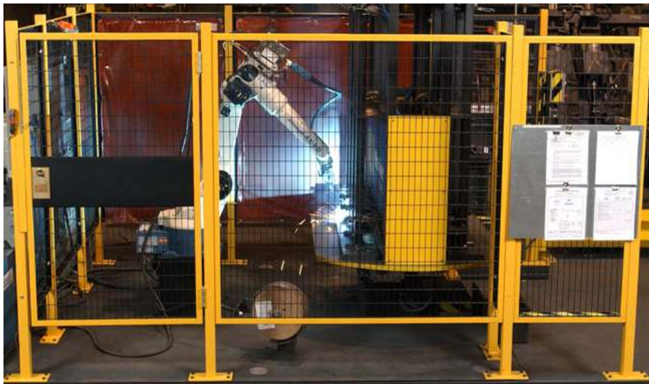
Slika 32. Zaštitna ograda od pletene žice [22]
