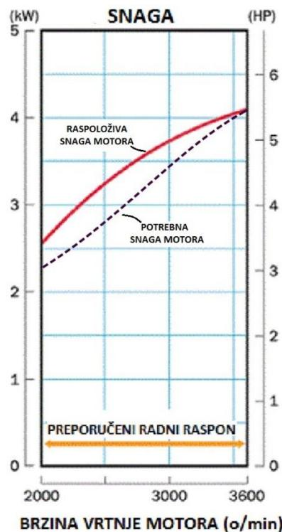
Slika 18. Usporedni dijagram raspoložive i potrebne snage motora
