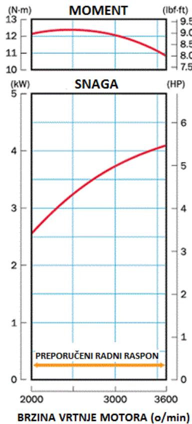
Slika 17. Dijagram snage i momenta pogonskog motora
