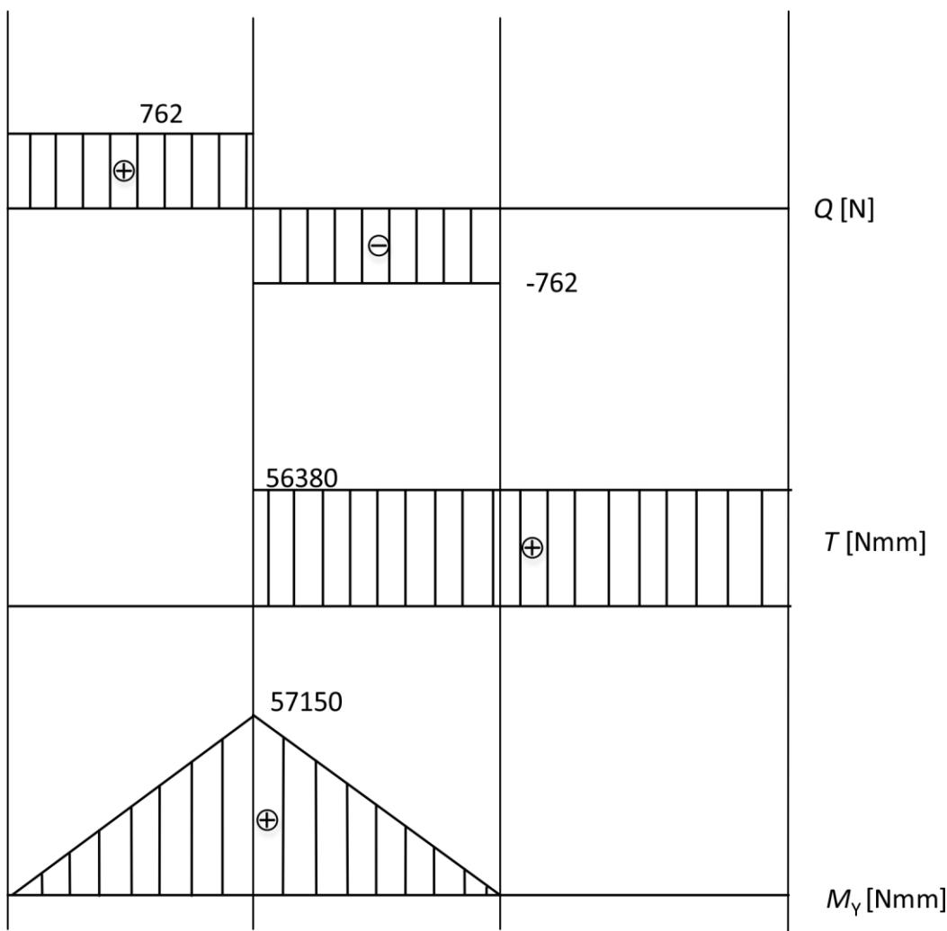
Slika 19. Dijagrami poprečnih sila, momenata savijanja te momenata uvijanja na gonjenom vratilu
