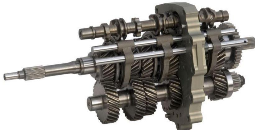
**Slika 4.**Prijenosnik sa skokovitom promjenom prijenosnog omjera
