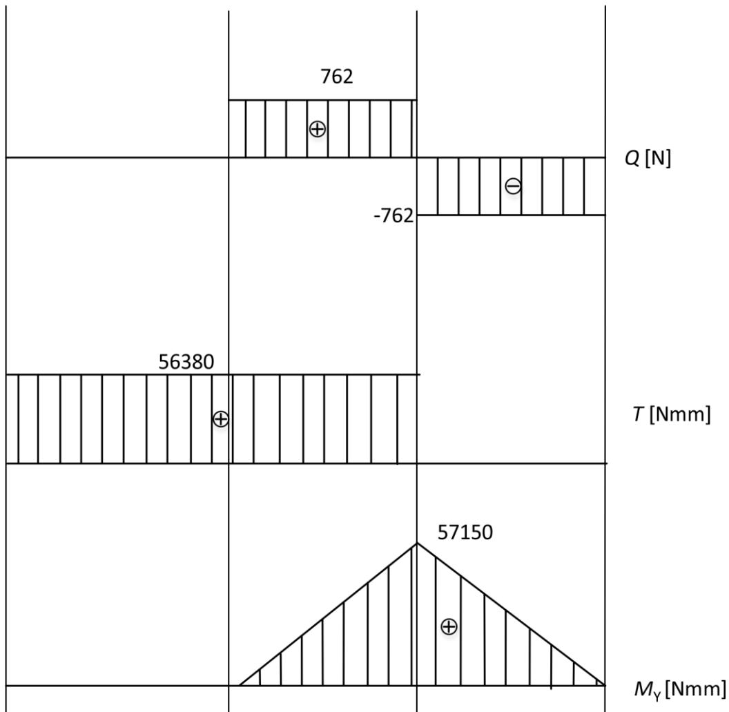
Slika 15. Dijagrami poprečnih sila, momenata savijanja i momenata uvijanja na pogonskom vratilu
