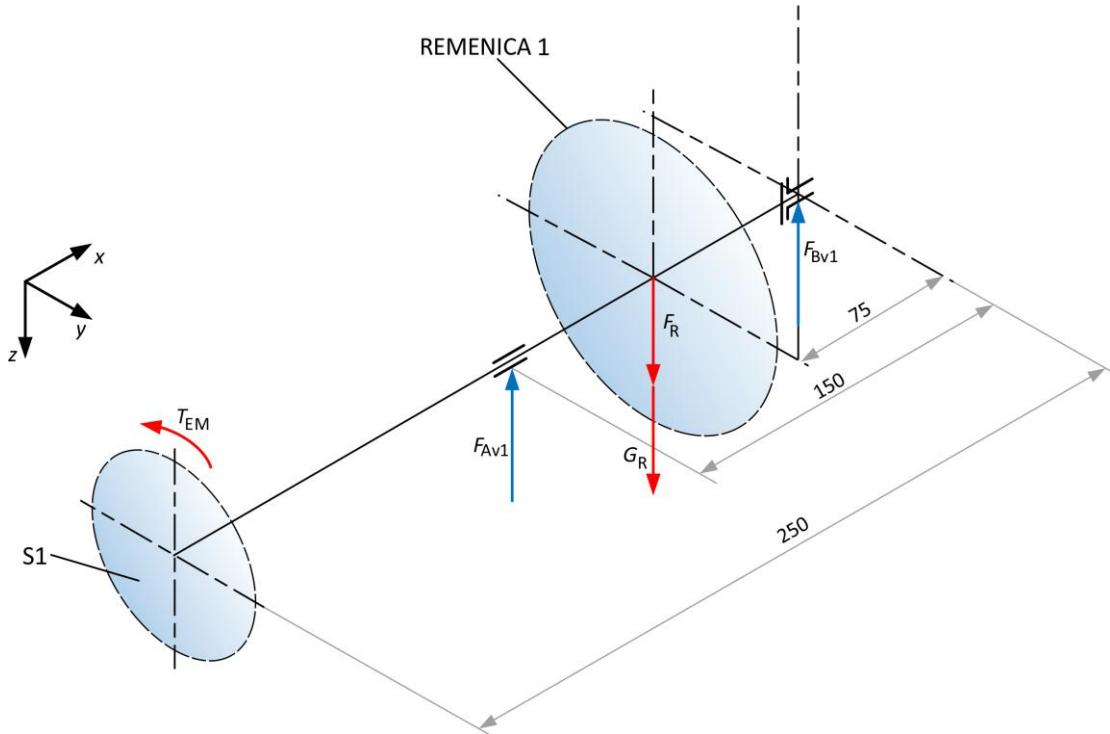
Slika 13. Shema opterećenja pogonskog vratila u izometriji
