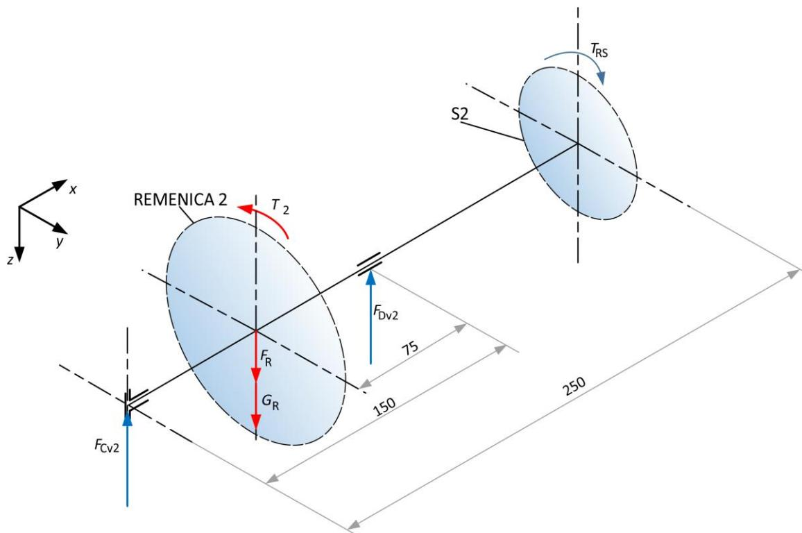
Slika 17. Shema opterećenja gonjenog vratila u izometriji
