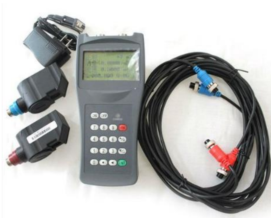
Slika 11. Ispitivano ultrazvučno mjerilo protoka [7]
