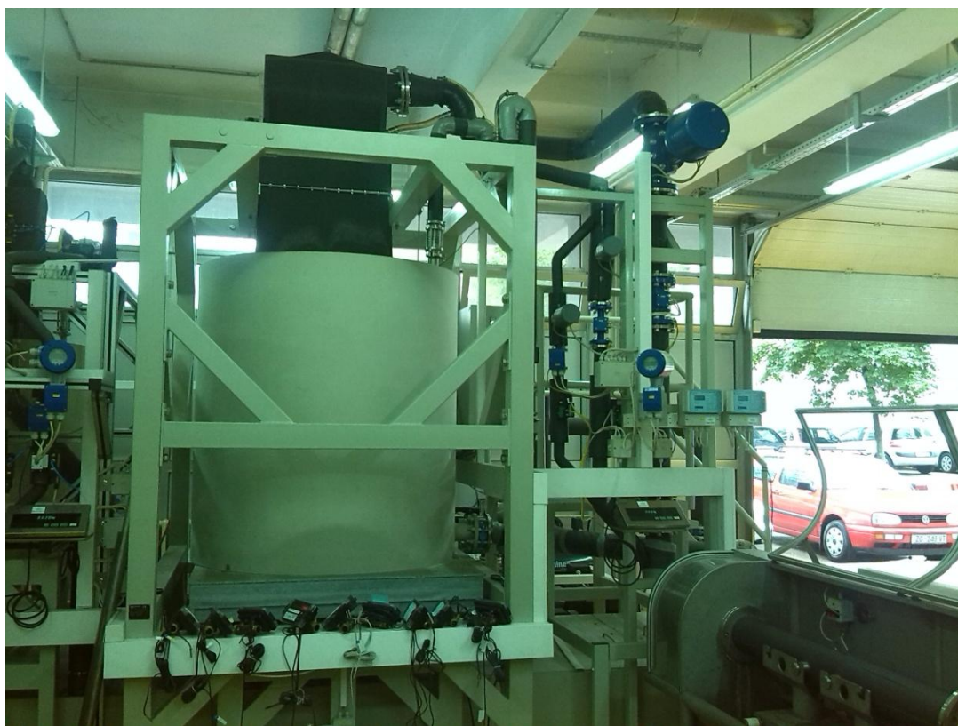
Slika 10. Spremnik na vagi mjerne linije G2T 90/50-100
