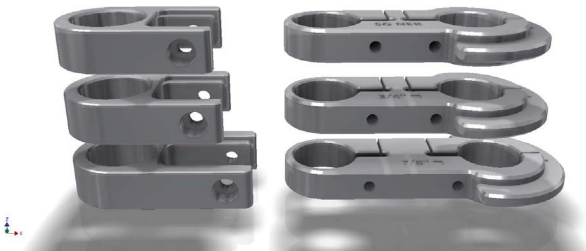
Slika 31. Nastavci za postizanje različitih osnih razmaka cijevnih vodilica
