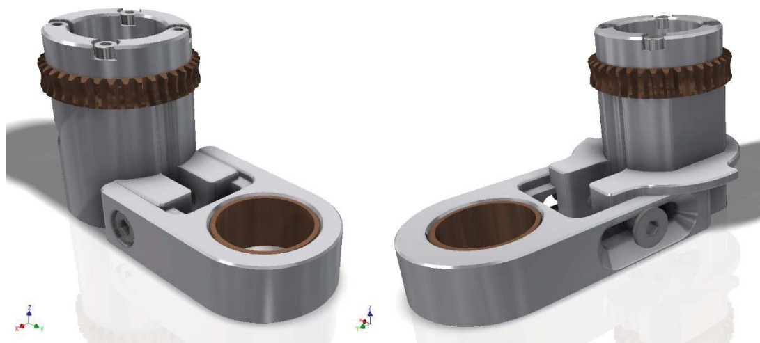
Slika 26. Različiti načini prilagodbe osnovnog razmaka čeljusti za rotaciju
