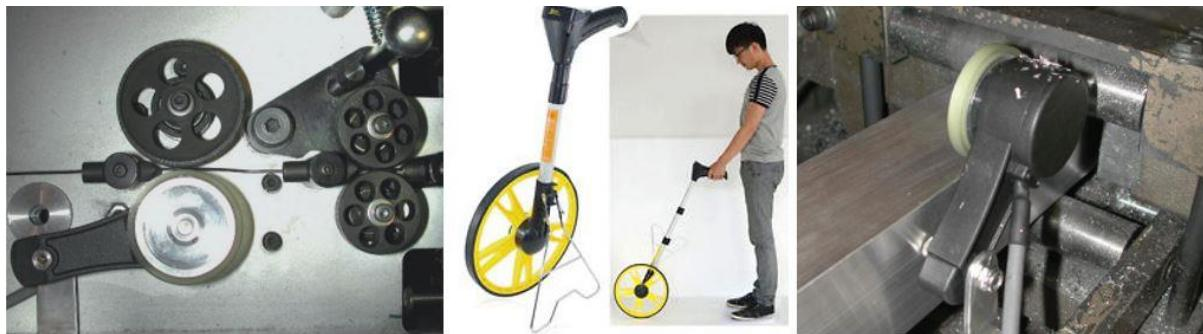
**Slika 9: Uređaji za mjerjenje duljine (udaljenosti)**
