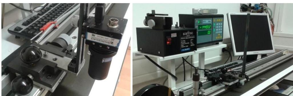
Slika 3: Sustav za mjerjenje duljine
