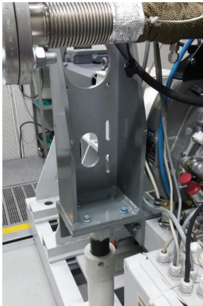
Slika 29. Nosiva konstrukcija na postavu
