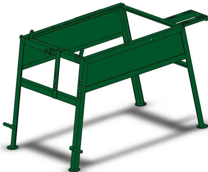
Slika 30 Kućište runilice
