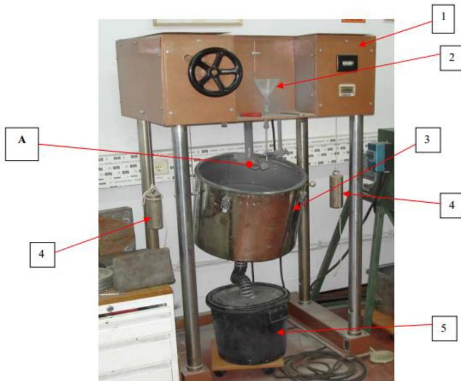
Slika 15. Uređaj za ispitivanje otpornosti na eroziju[11]
