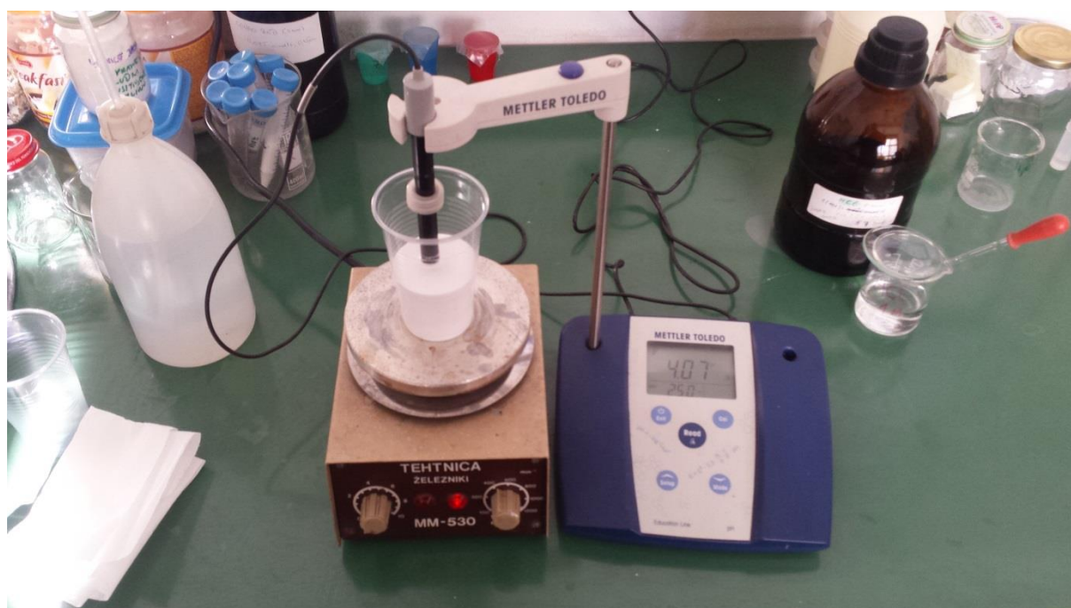
Slika 19. Mjerenje pH-vrijednosti suspenzije
