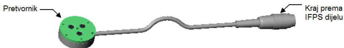
Slika 4. Integrirani kabel s malim mjernim pretvornikom [2]
