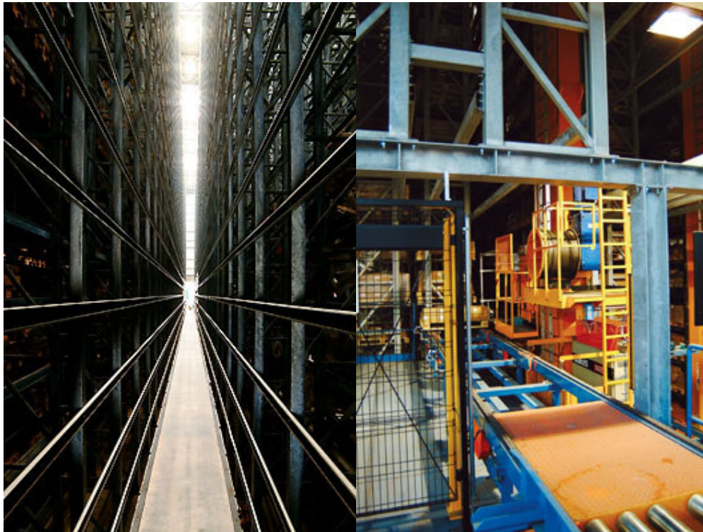
Slika 2.3. Primjer samonosećeg automatiziranog skladišta [7]
