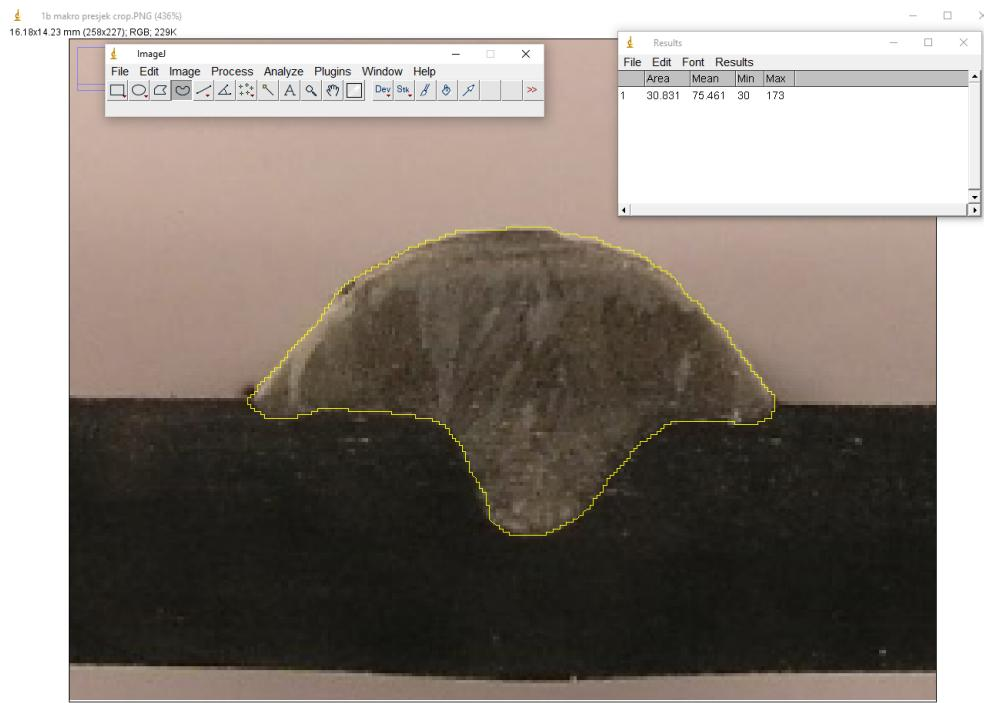
Slika 32 Mjerenje površine pomoću programa ImageJ
