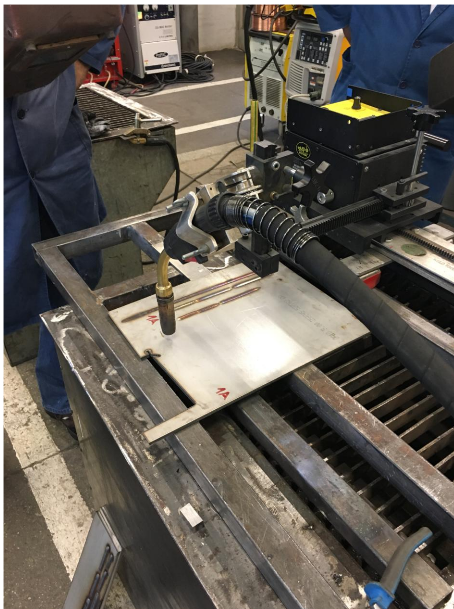
Slika 21 Postav eksperimenta za navarivanje
