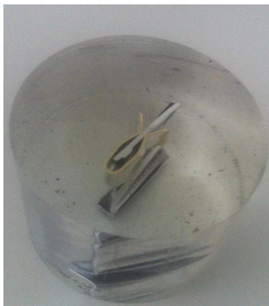
Slika 25. Pripremljeni i uliveni uzorak metalnog kućišta za daljnu analizu
