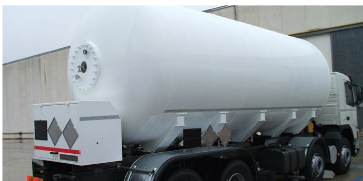
Slika 13 – Tlačni spremnik za transport tekućih plinova
