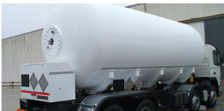
Slika 13 – Tlačni spremnik za transport tekućih plinova
