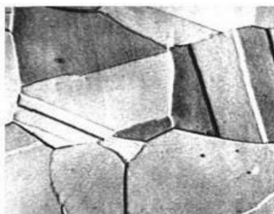
Slika 9 – Austenitna mikrostruktura kod čelika
