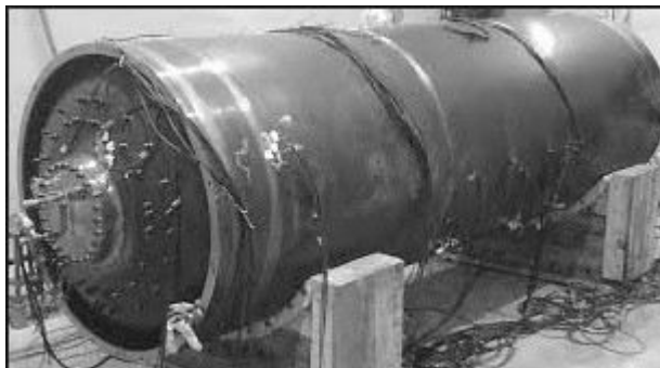
Slika 21 – Kućište raketnog motora izrađenog od "maraging" čelika
