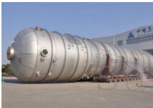
Slika 23 – Tlačni spremnik izrađen od dupleks nehrđajućeg čelika
