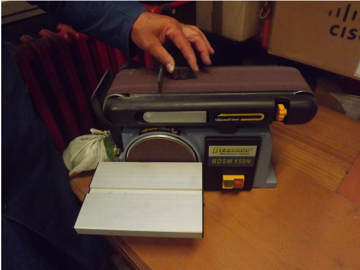
Slika 49. Brušenje makroizbruska na traci
