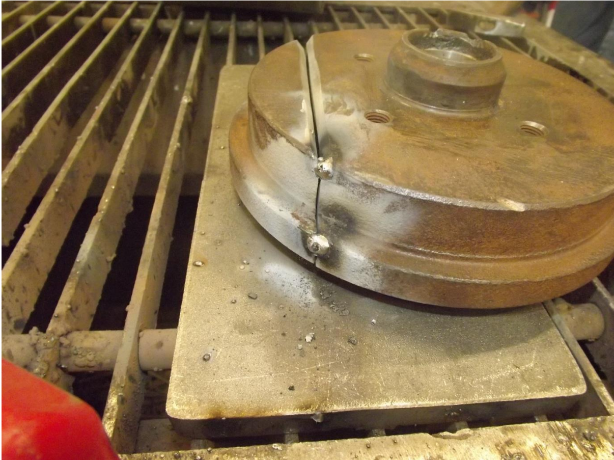
Slika 35. Radni komad s pripojima
