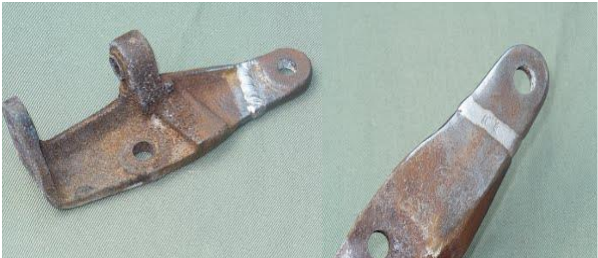
Slika 17. Držač zavaren na hladno [16]
