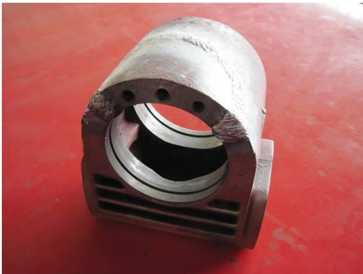
Slika 16. Kućište cilindra preše zavarena na hladno [10]
