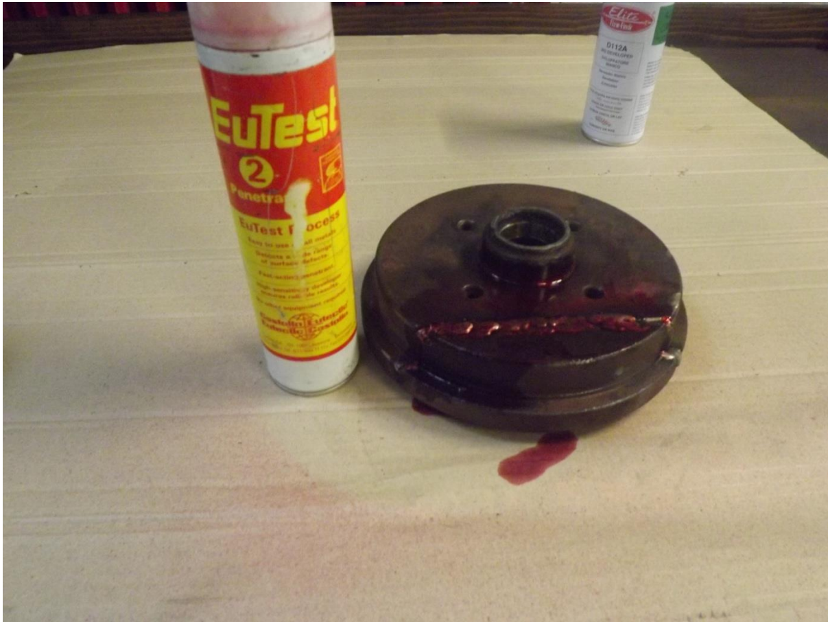
Slika 46. Penetriranje radnog komada
