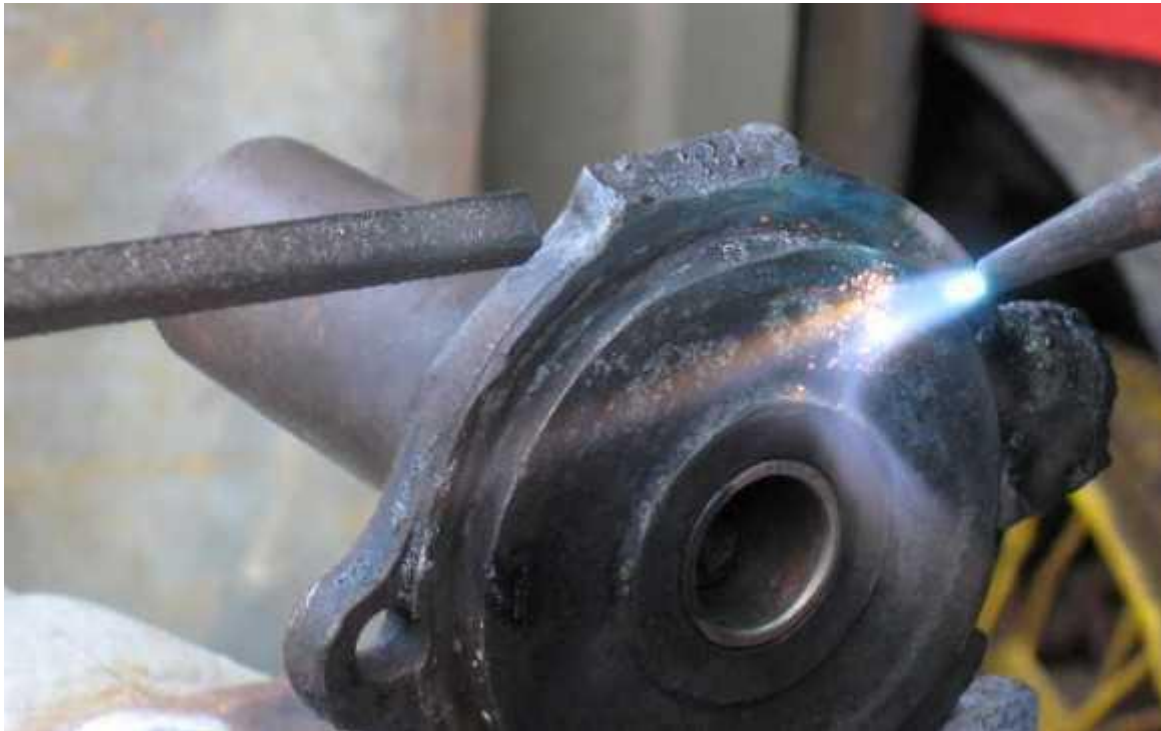
Slika 14. Zavarivanje plinskim plamenom tuljka hidranta [15]
