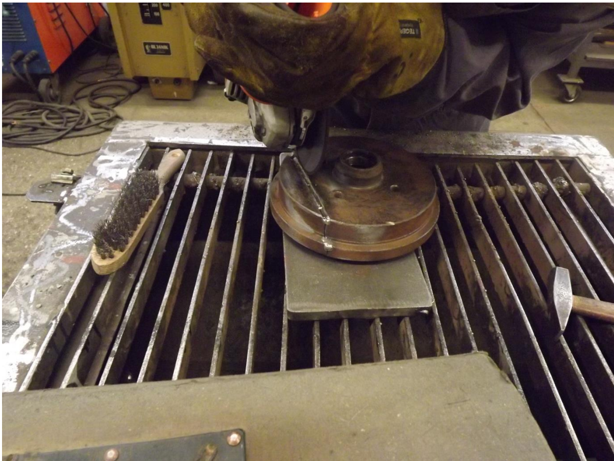
Slika 41. Uklanjanje troske kutnom brusilicom
