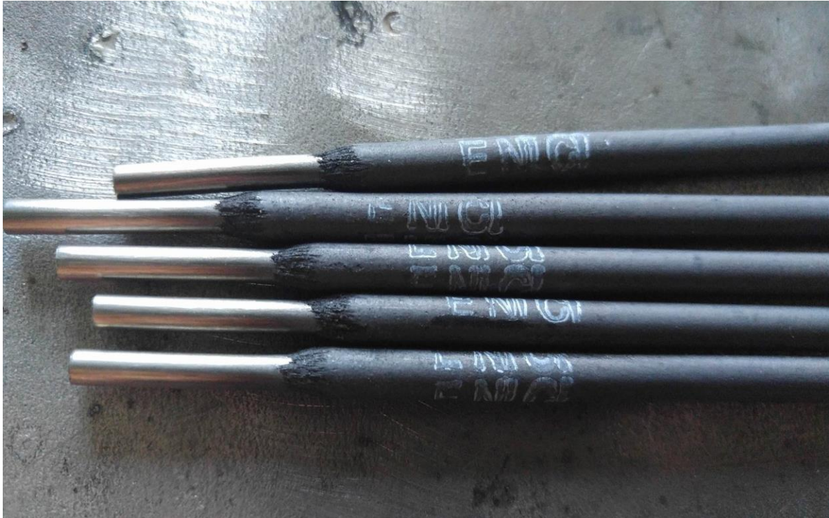
Slika 13. Elektrode za zavarivanje sivog lijeva na toplo [10]
