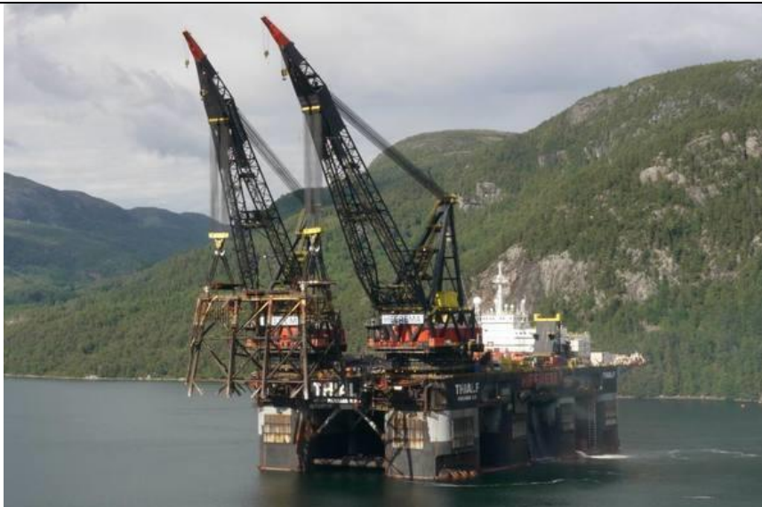
Slika 37. Thialf kod podizanja jacketa ( heerema.com/fleet )
