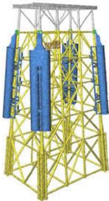
Slika 43. Uzgonski elementi na jacketu [8]
