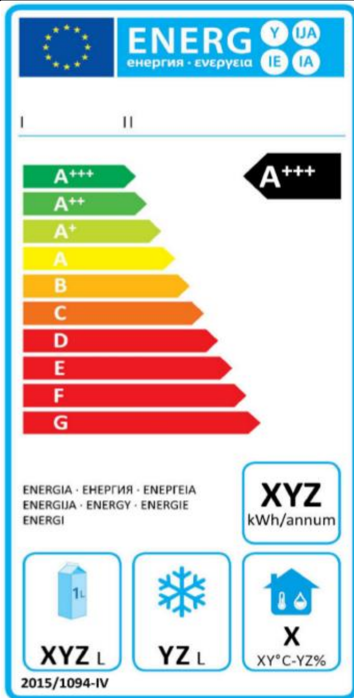
Slika 9. Energetska iskaznica s razredima energetske učinkovitosti profesionalnih rashladnih ormara svrstanih u razrede energetske učinkovitosti od A+++ do G. [14]
