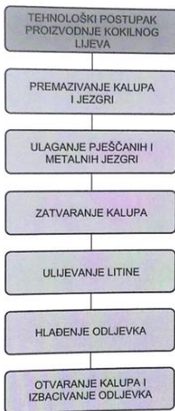
Slika 4. Tehnološki postupak proizvodnje kokilnog lijeva [1]
