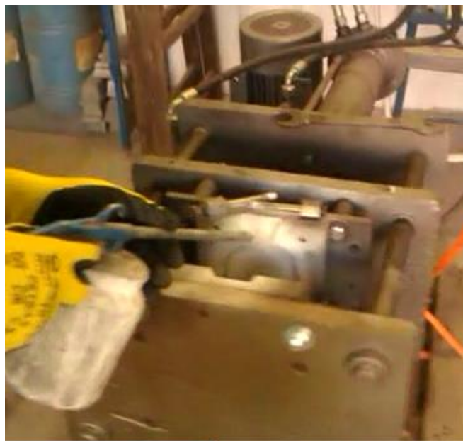
Slika 52. Nanošenje premaza na kokilu
