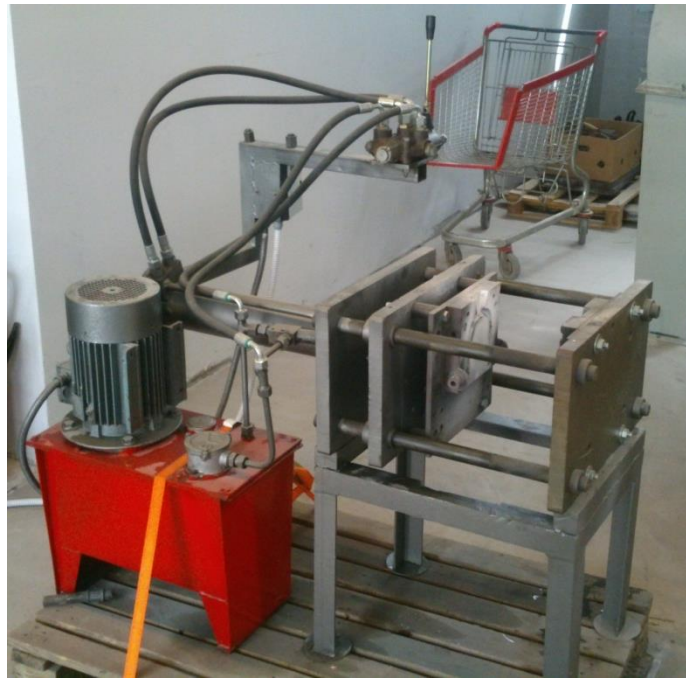
Slika 48. Kokilni stroj za lijevanje, otvoren kalup
