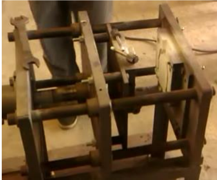
Slika 54. Otvaranje kokile nakon lijevanja
