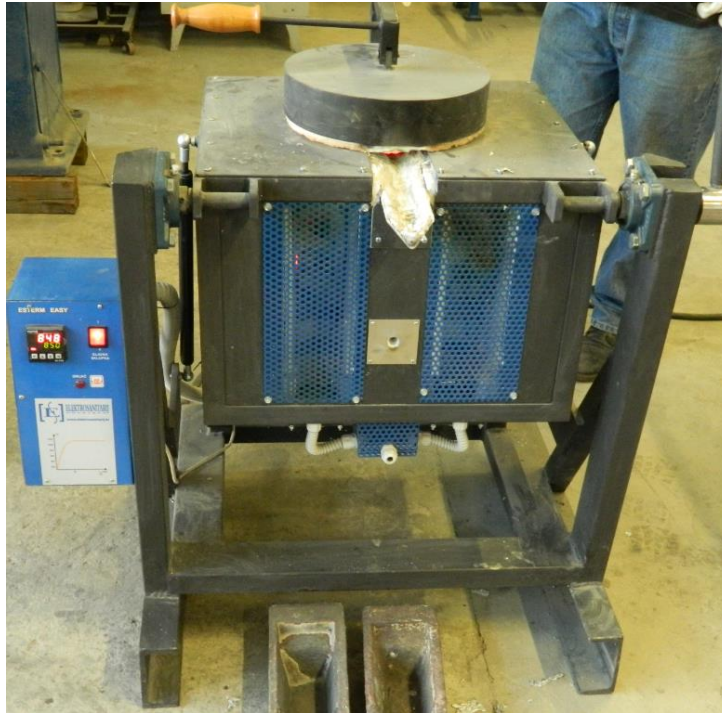
Slika 44. Elektrootporna peč za taljenje
