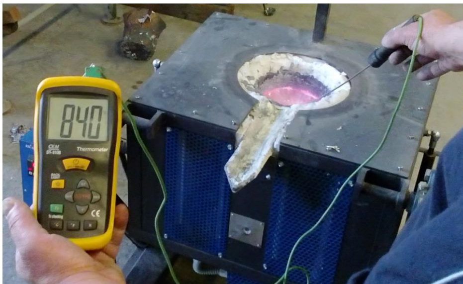
Slika 47. Mjerenje temperature taljevine
