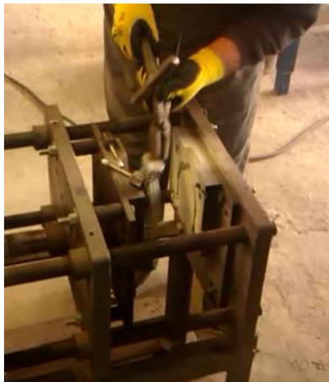
Slika 55. Vađenje odljevka nakon hlađenja
