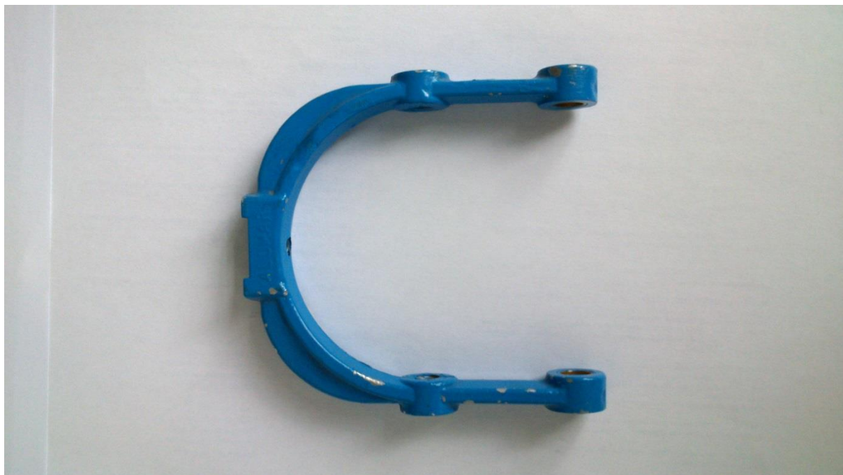
Slika 20. Vilica od aluminijske legure
