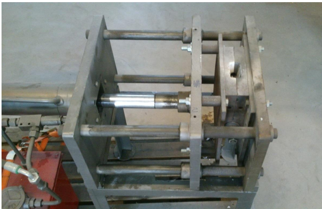
Slika 49. Mehanizam sa otvaranje i zatvaranje kokile, zatvoren kalup
